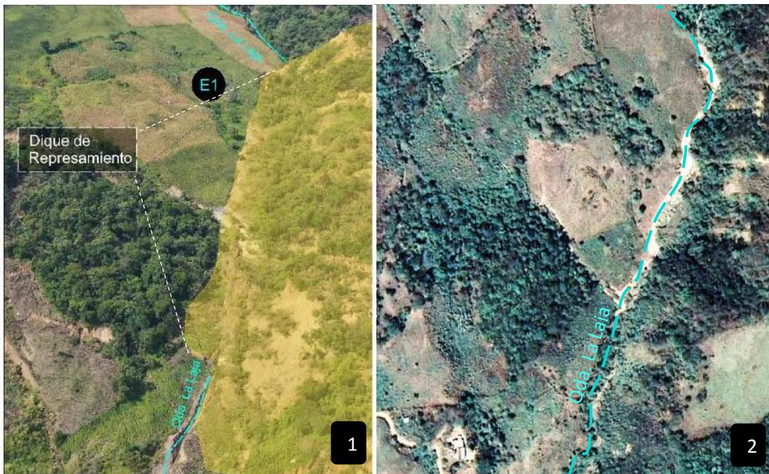
**Figura 08** (1) Ortofoto del 11/03/2022, zona de embalse en quebrada La Laja (E1), en color amarillo material deslizado (deslizamiento D2), en color cian cauce de río represado (2) Imagen
