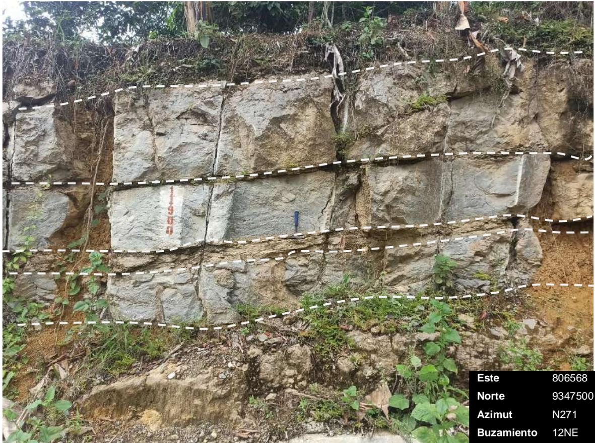
Fotografía 02. Calizas arcillosas grises moderadamente fracturadas intercaladas con arcillitas beige muy fracturadas y meteorizadas
