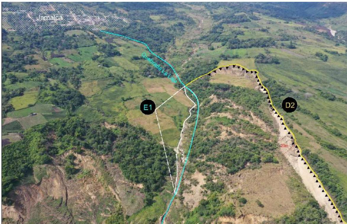
**Fotografía 06.** (D2) Deslizamiento rotacional al noroeste del centro poblado Jamalca, generó embalse en la quebrada La Laja
