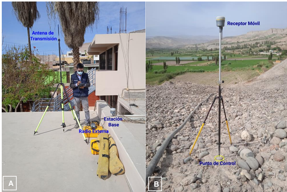
Figura 8. Instalación de Equipos para Levantamiento GNSS RTK. Los valores de corrección se envían directamente por radio desde la estación base al receptor móvil. De esta manera, con este último se puede registrar continuamente su posición relativa al punto de referencia con una precisión por debajo del decímetro. (A) Receptor móvil ubicado en la municipalidad de Vitor. (B) Receptor móvil tomando coordenadas en punto de control de la red de monitoreo.
