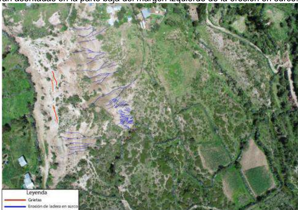
Figura 20. Se muestra erosión de ladera en surco enmarcado con líneas de color azul y grietas con líneas de color rojo, ubicado al sureste del Anexo Quilla. Con coordenadas UTM (WGS 84): 601875 E; 8485306 S.
