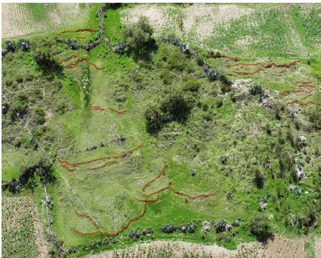
Figura 17. Se muestra el proceso de reptación de suelos enmarcado con líneas de color rojo. Con coordenadas UTM (WGS 84): 602485 E; 8485103 S.
