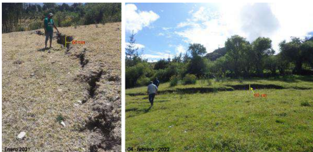
Figura 13. Muestra la comparación de la dimensión del escarpe principal del deslizamiento, enero 2021 y febrero 2022.
