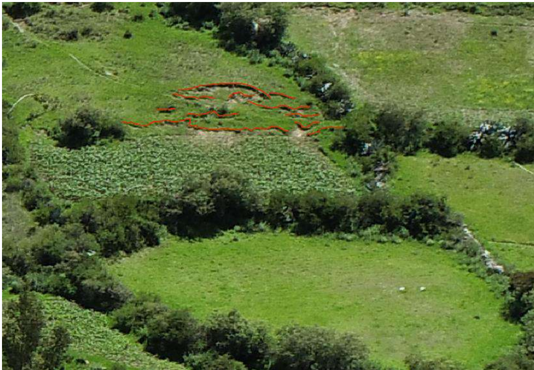
Figura 19. Se muestra el proceso de reptación de suelos enmarcado con líneas de color rojo, ubicado en el flanco sur del cerro Lasaraya. Con coordenadas UTM (WGS 84): 602693.63 E; 8485372.23 S.
