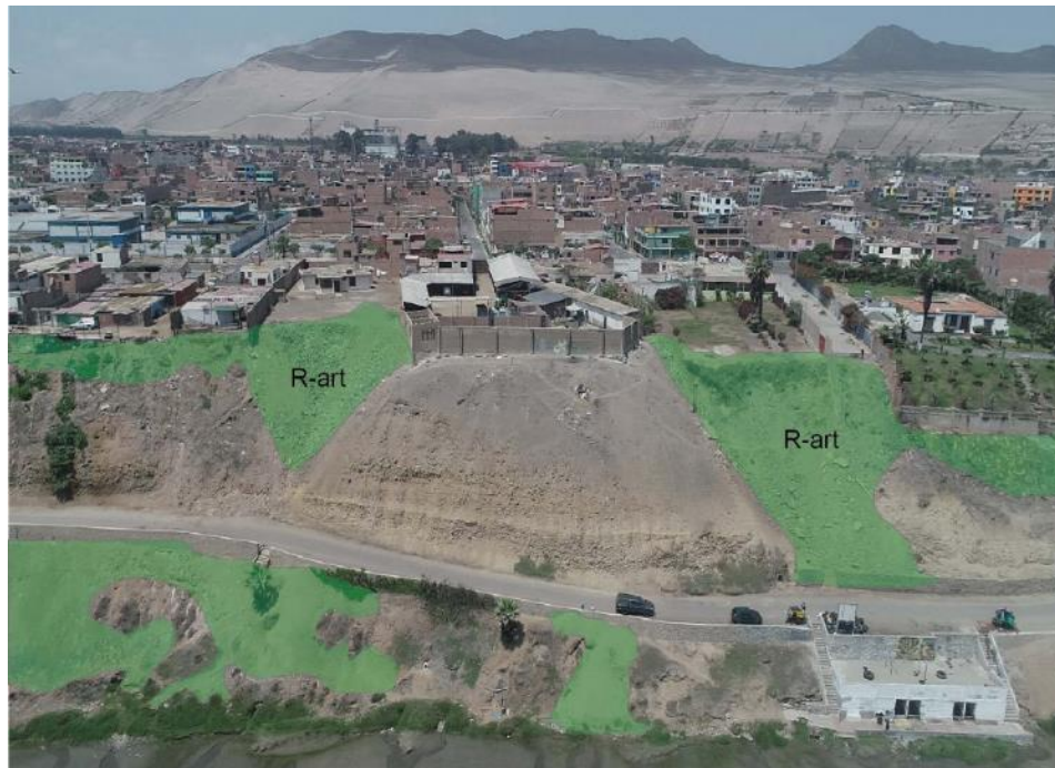
Figura 9. Geofomas de relleno artificial sobre las cuales se asientan viviendas de la zona urbana de Chancay.
