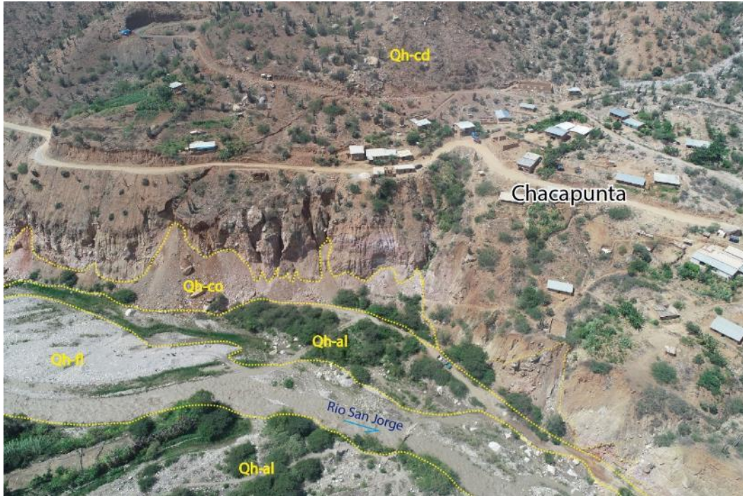
Figura 11. Obsérvese los depósitos coluviales (Qh-co), formando talus de detritos en la margen izquierda del río San Jorge. En la margen izquierda y derecha se observan depósitos aluviales y fluviales, producto de la dinámica fluvial.
