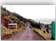
34. Lote E-3 para la construcción de una vivienda se recomienda la remoción del material coluvio – deluvial de la zona, la estabilización del talud con muros de contención tipo andenería y construcción con un proyecto de vivienda.
