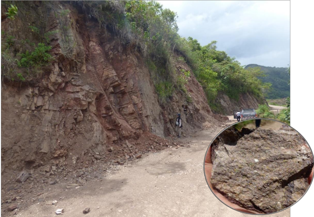
Figura 5. Afloramiento de brechas y diques volcánicos, intercaladas con areniscas de grano medio a grueso y limolitas de color pardo rojizo.
