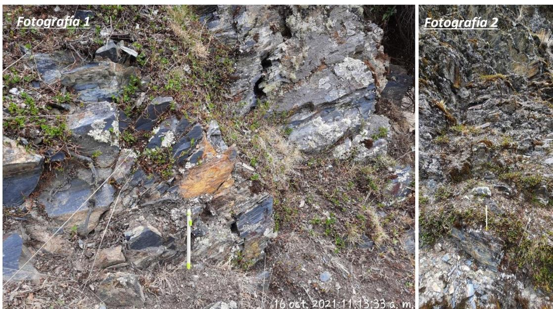
**Fotografía 1 y 2.** Pizarras ligeramente meteorizadas y con alto fracturamiento en el área de estudio, en las coordenadas UTM X: 804742 Y: 8538552.
