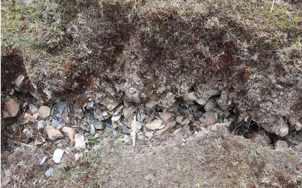
**Fotografía 5:** Bloques angulares de pizarras sueltos en las aperturas del terreno, sobre el sector de Facchac Alta (área de estudio).
