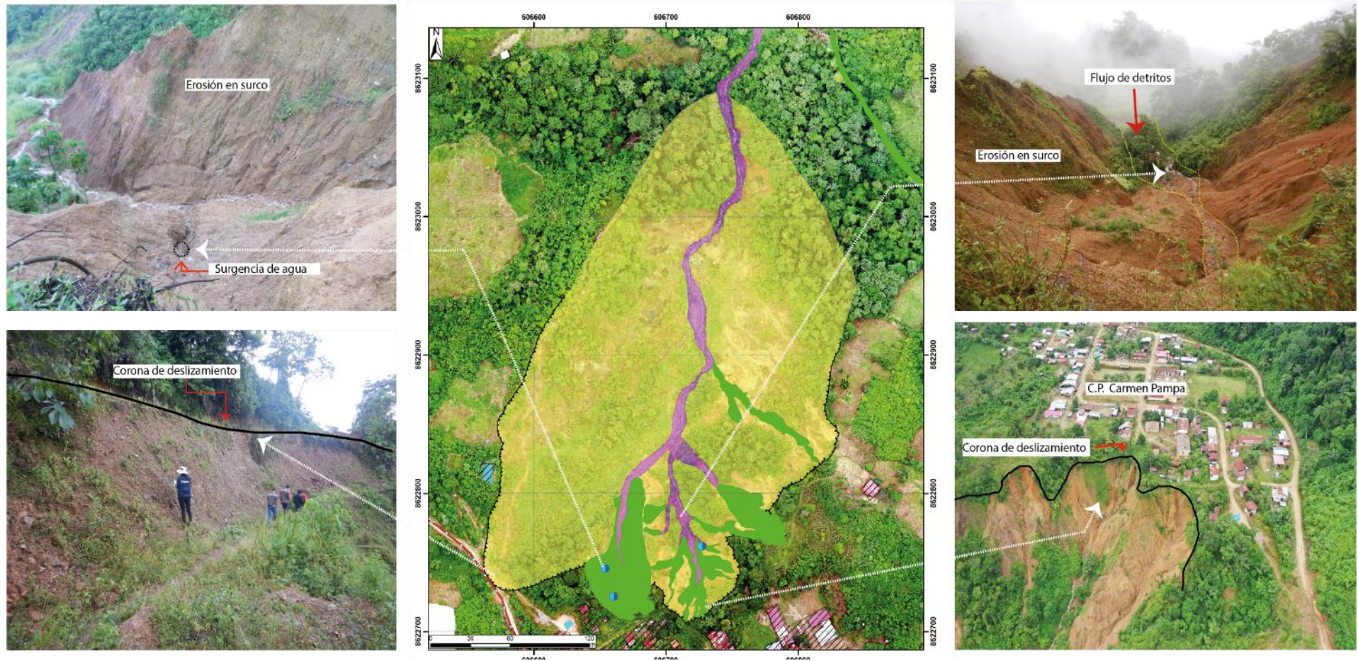
Figura 22. Cartografía de peligros por deslizamiento, erosión de laderas en cárcava y procesos asociados (flujo de detritos), donde se muestra con fotografías algunos puntos de interés.
