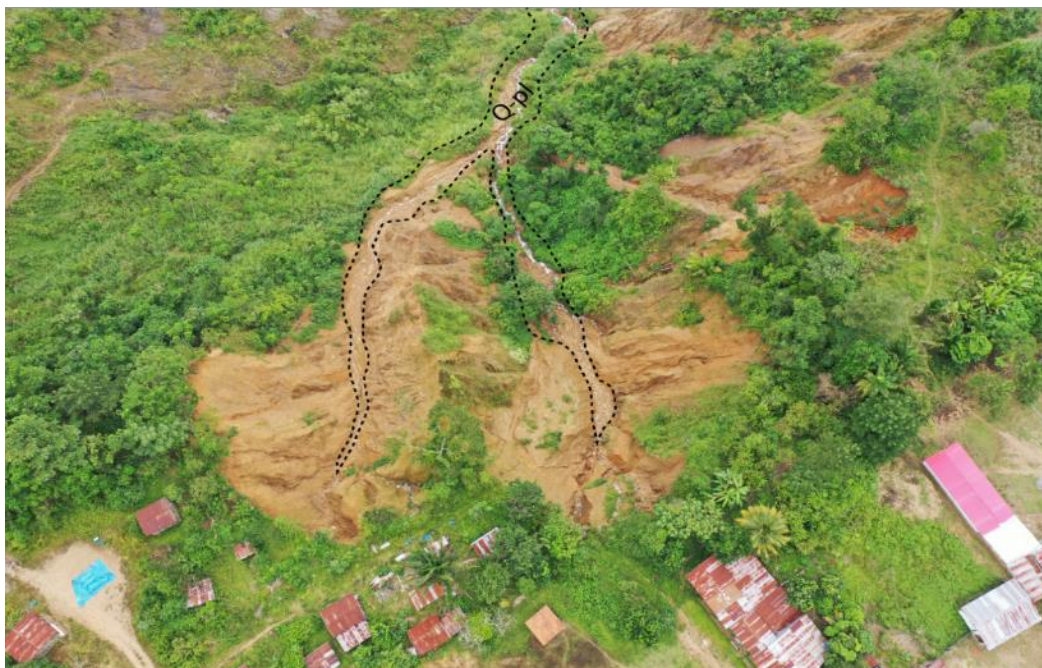
Figura 6. Vista del depósito proluvial (Q-pl), ubicado en el cuerpo del deslizamiento, este depósito es producto del arrastre del material acumulado por el proceso de erosión de laderas.
