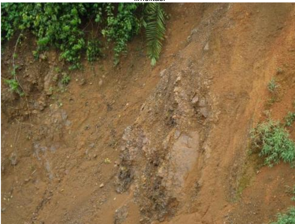
Fotografía 2. Vista del afloramiento de limolitas muy fracturadas y altamente meteorizadas del Grupo Ambo.
