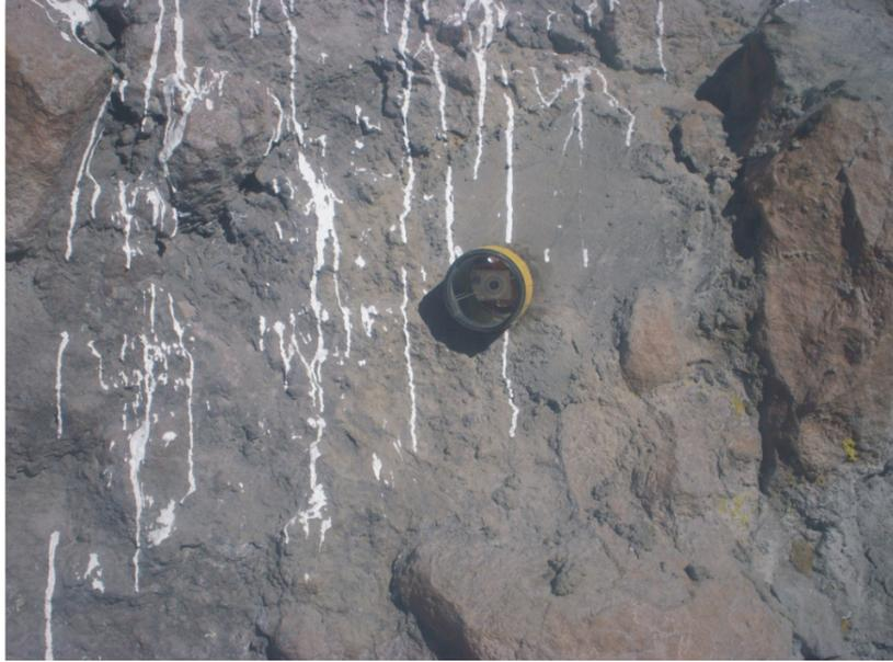
**Figura 7.** Estación soporte de prismas UD15.
