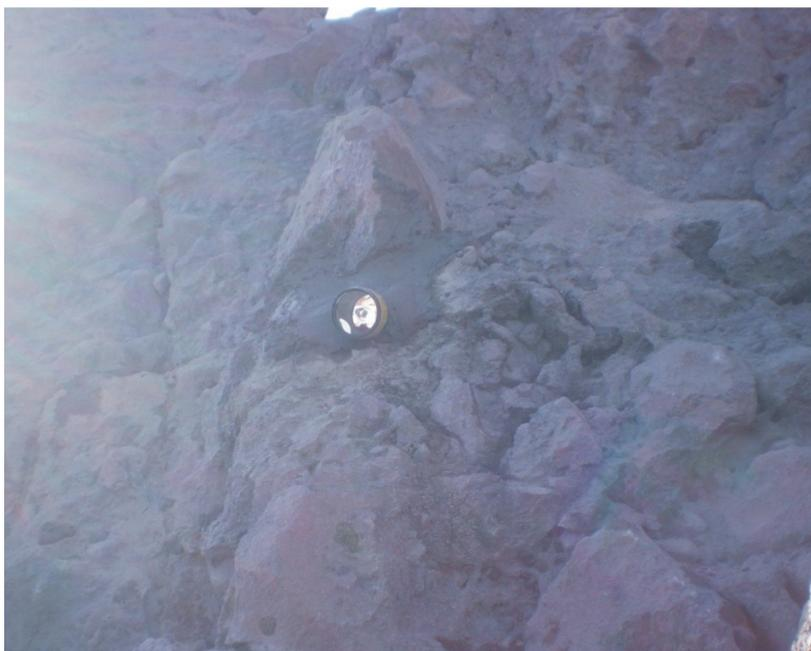
**Figura 9.** Estación soporte de prismas UD17
