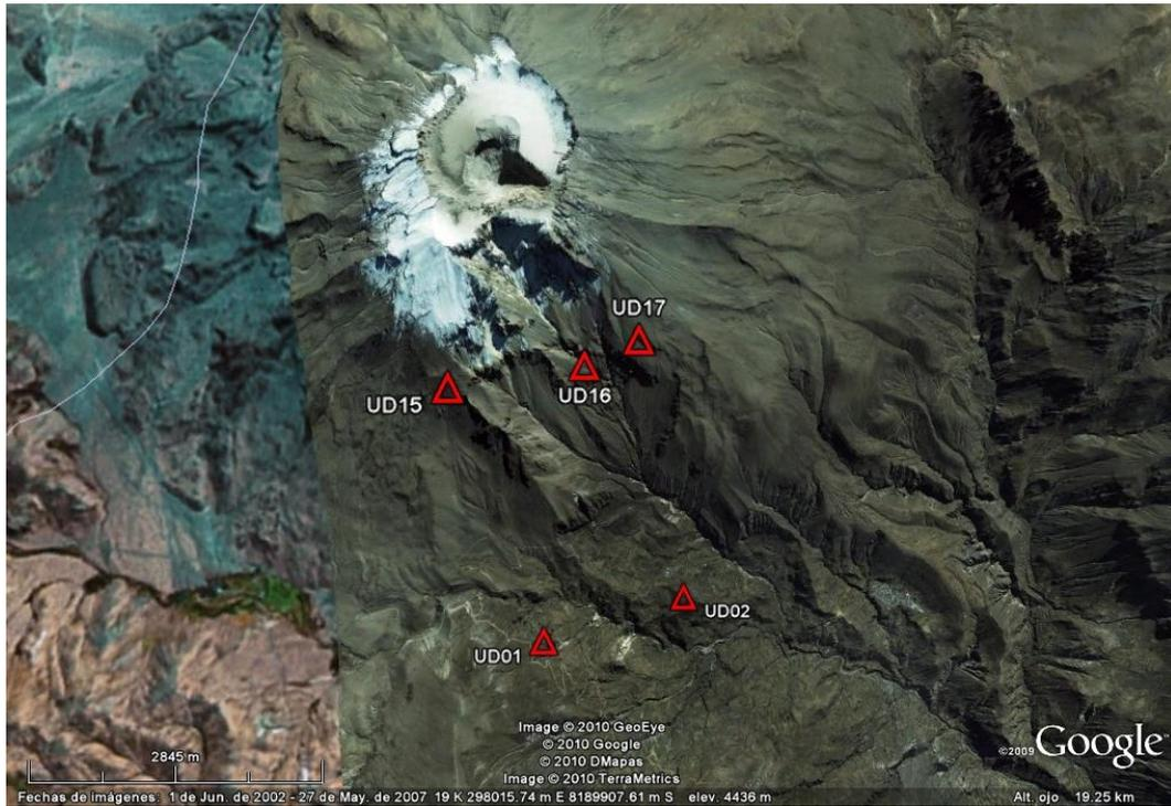
**Figura 4.** Ubicación de los puntos de control del monitoreo de deformación del flanco sur del volcán Ubinas. UD01 y UD02 son estaciones base y UD15, UD16 y UD17 estaciones soporte de prismas.
