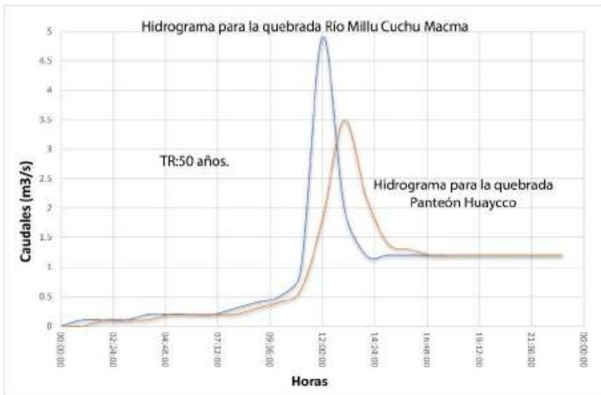
Figura 37. Hidrograma de caudales para un TR: 50 años, en las quebradas río Millu Cuchu Macma y panteón Huaycco.
