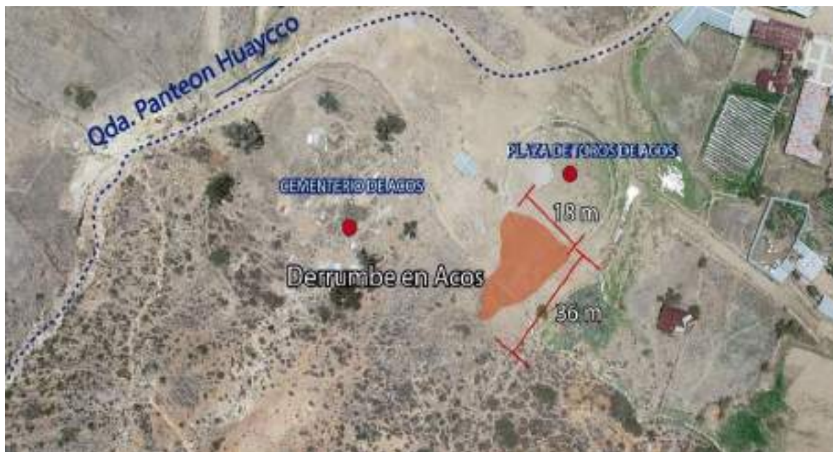
Figura 26. Dimensiones en una vista aérea del derrumbe identificado en la ladera noreste del cerro Anchacata, derecha de la quebrada Panteón Huaycco.
