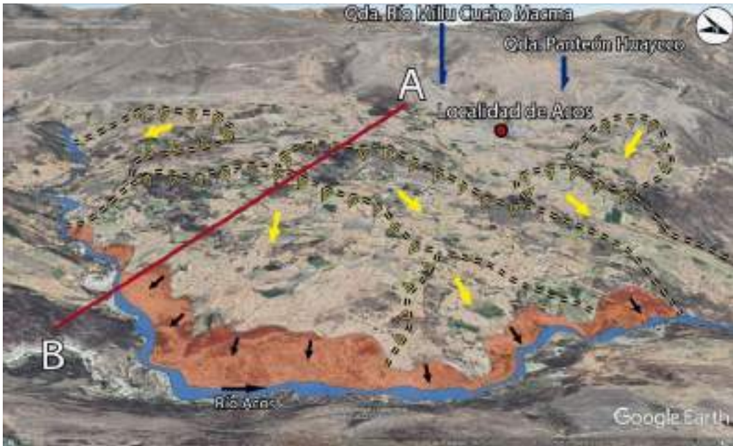
Figura 23. Derrumbes en la margen izquierda del río Acos, de los pies de deslizamiento ubicados debajo de la localidad de Acos.
