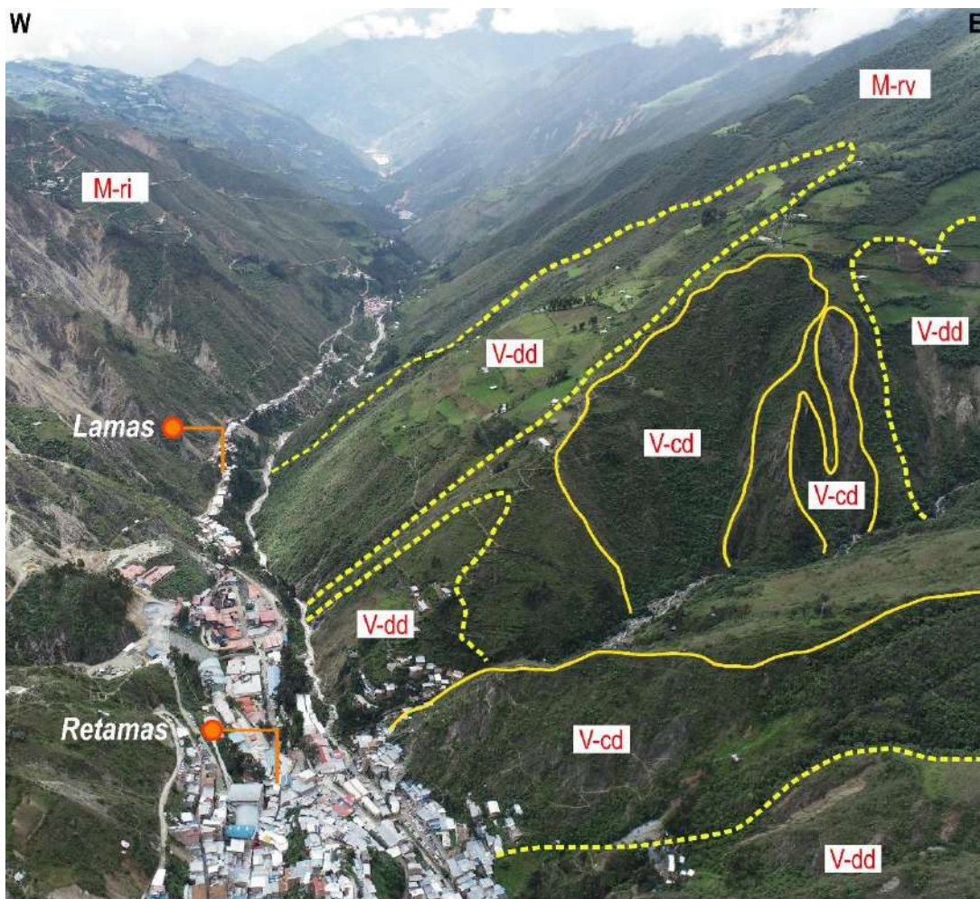
Figura 10. Demarcados por líneas discontinuas color amarillo se observa las subunidades de vertiente con depósito de deslizamiento (V-dd) ubicado frente al sector de Lamas, y con líneas continuas amarillas la subunidad coluvio-deluvial (V-cd) ubicado al pie de ladera de montaña modelada en volcánica (M-rv).
