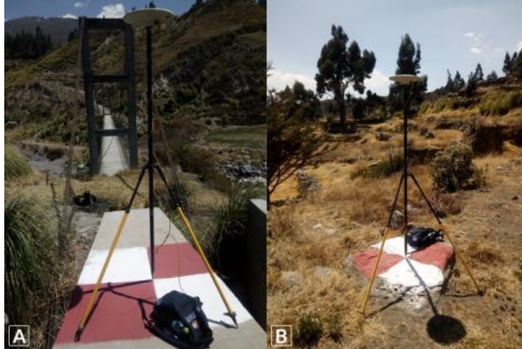
Figura 13. Marcas de pintura con centro claramente definido en infraestructura existente (A) y en roca (B)
