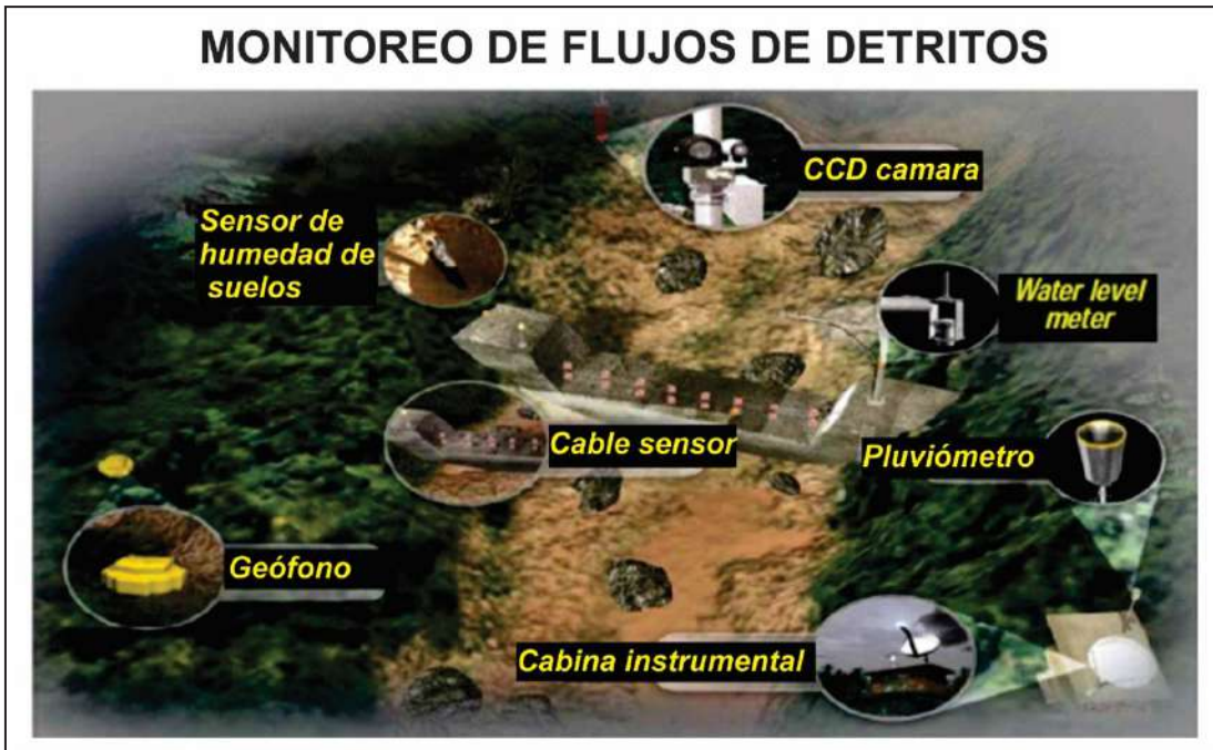
Figura 11.32 Sensores utilizados para el monitoreo de flujos de detritos (Soil and Water Conservation Bureau SWCB).
