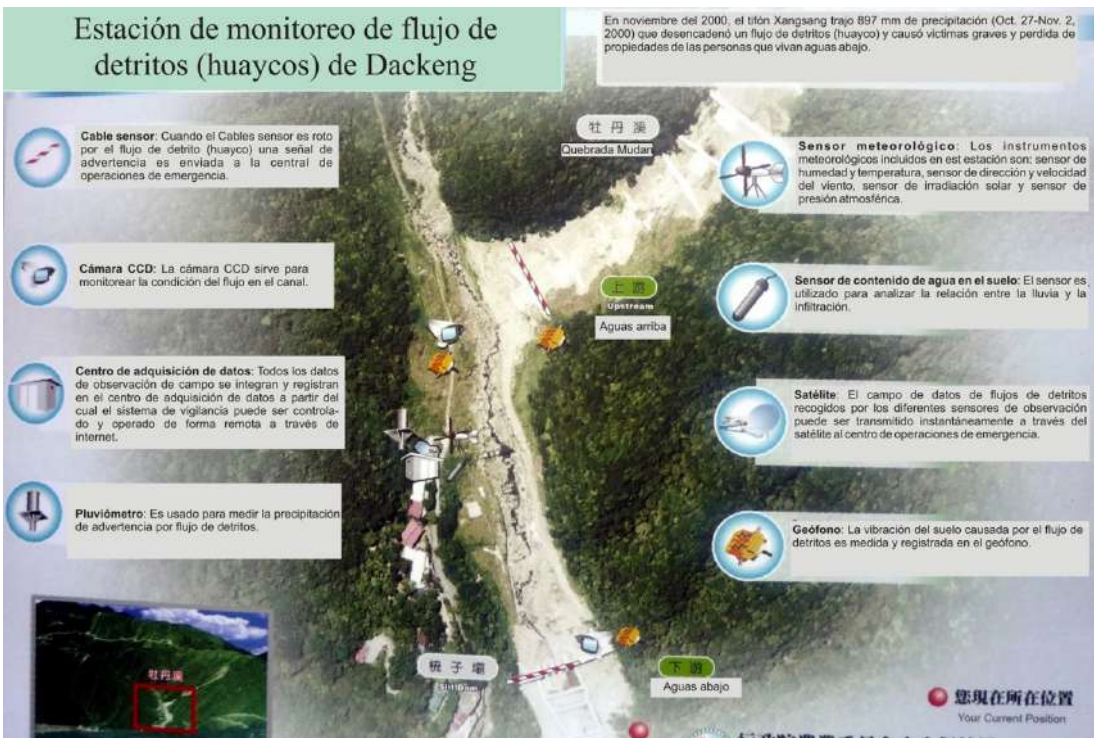
Figura 11.33 Estación de monitoreo de flujo de detritos (Soil and Water Conservation Bureau SWCB).
