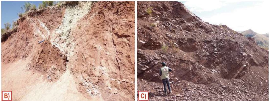
Figura 4.18 a) valor GSI estimado para la subunidad de arcillitas y areniscas; b) formado por un macizo desintegrado sin discontinuidades visibles, gran contenido de material fino y fuertemente meteorizado; c) macizo fracturado y perturbado, con numerosas discontinuidades e igualmente muy meteorizado.
