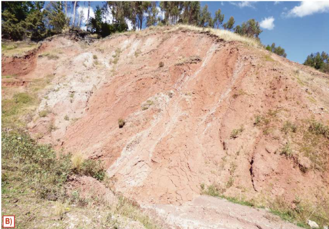
Figura 4.20 a) valor de GSI estimado para la subunidad de yesos; b) macizo desintegrado sin discontinuidades visibles, gran contenido de material fino y fuertemente meteorizado.
