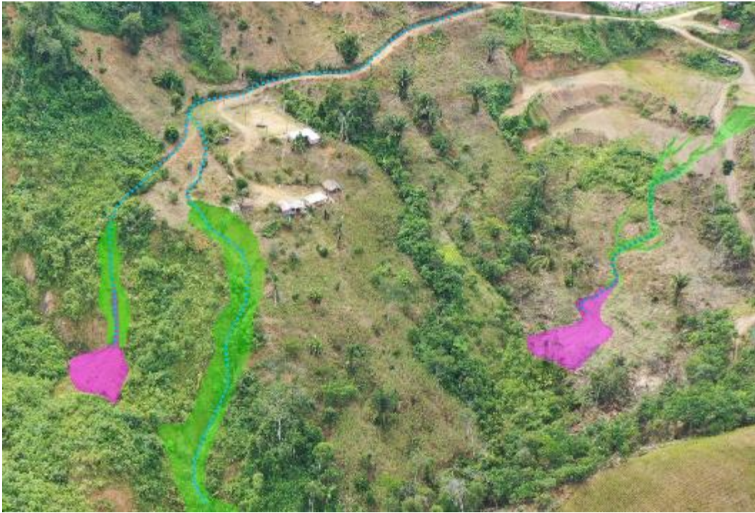
Figura 26. Vista de erosión de laderas de tipo cárcavas, donde el material acumulado al pie es arrastrado por las aguas que discurren por la zona torrente aguas abajo, en forma de flujo de detritos.
