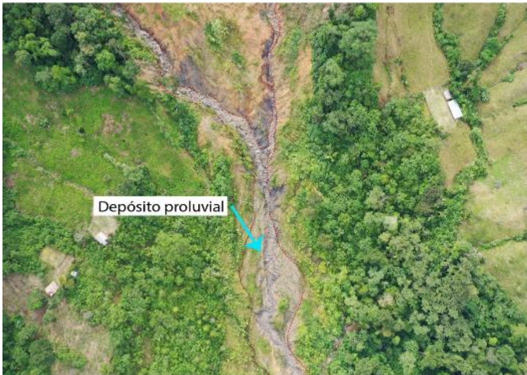
Figura 6. Depósito proluvial (Q-pl), ubicado en la quebrada Chirapayoc que discurre con dirección NW-SE.
