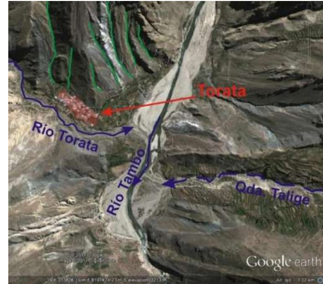
Figura 12. Poblado Torata asentado en la margen izquierda del río Torata, se encuentra sobre una terraza proluvial (generados por flujos). En color verde, se muestran las erosiones de ladera. También se muestra el depósito en abanico dejado por la quebrada Talige.
