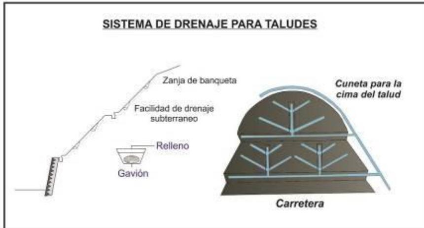
**Figura 8.** Sistema de drenaje tipo espina de pez.
