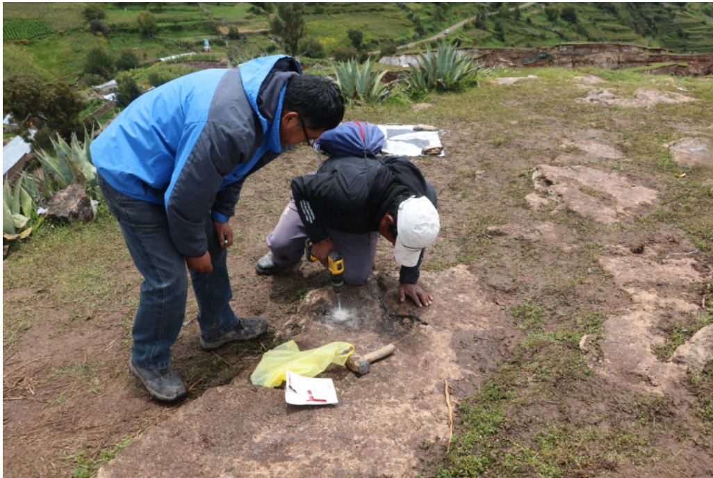
Foto A1. Trabajos de perforación en cuerpos rocosos para instalación de puntos de control, que nos permitan monitorear el movimiento del deslizamiento y alrededores.
