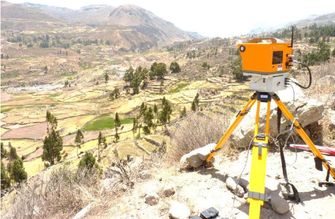
Foto 20: LiDAR instalado frente al deslizamiento de Lari, en las primeras tomas de prueba y calibración del equipo.
