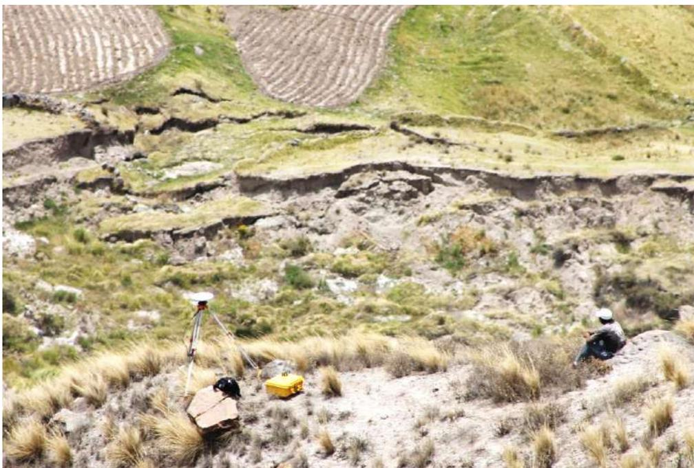
Foto 18: Instalación de una estación de GPS diferencial en el cuerpo del deslizamiento de Lari
