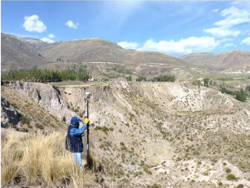
Foto 21. Levantamiento geodésico de la escarpa del deslizamiento de Lari, mediante el método GPS-RTK.
