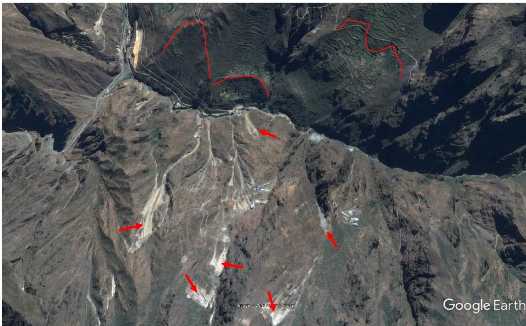
Figura 3: Cuenca baja de la quebrada Parac/Aruri. Obsérvese, en la margen izquierda, las escombreras y depósitos de estériles de las labores mineras (flechas rojas); así como algunas cicatrices de antiguos deslizamientos en la margen derecha (líneas rojas)
