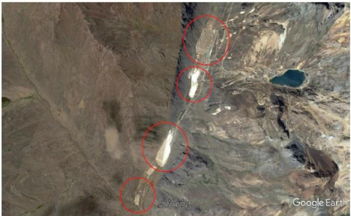
Figura 5: Relaveras de la Antigua mina Proaño. Se ubican en la cuenca alta y sobre el cauce de la quebrada Parac/Aruri, sin aparente protección.
