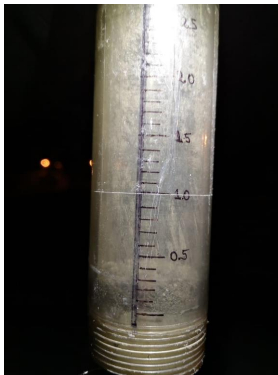
Figura 6: Cenizómetro UC-03, recolectado 0.2 mm de caídas de cenizas
