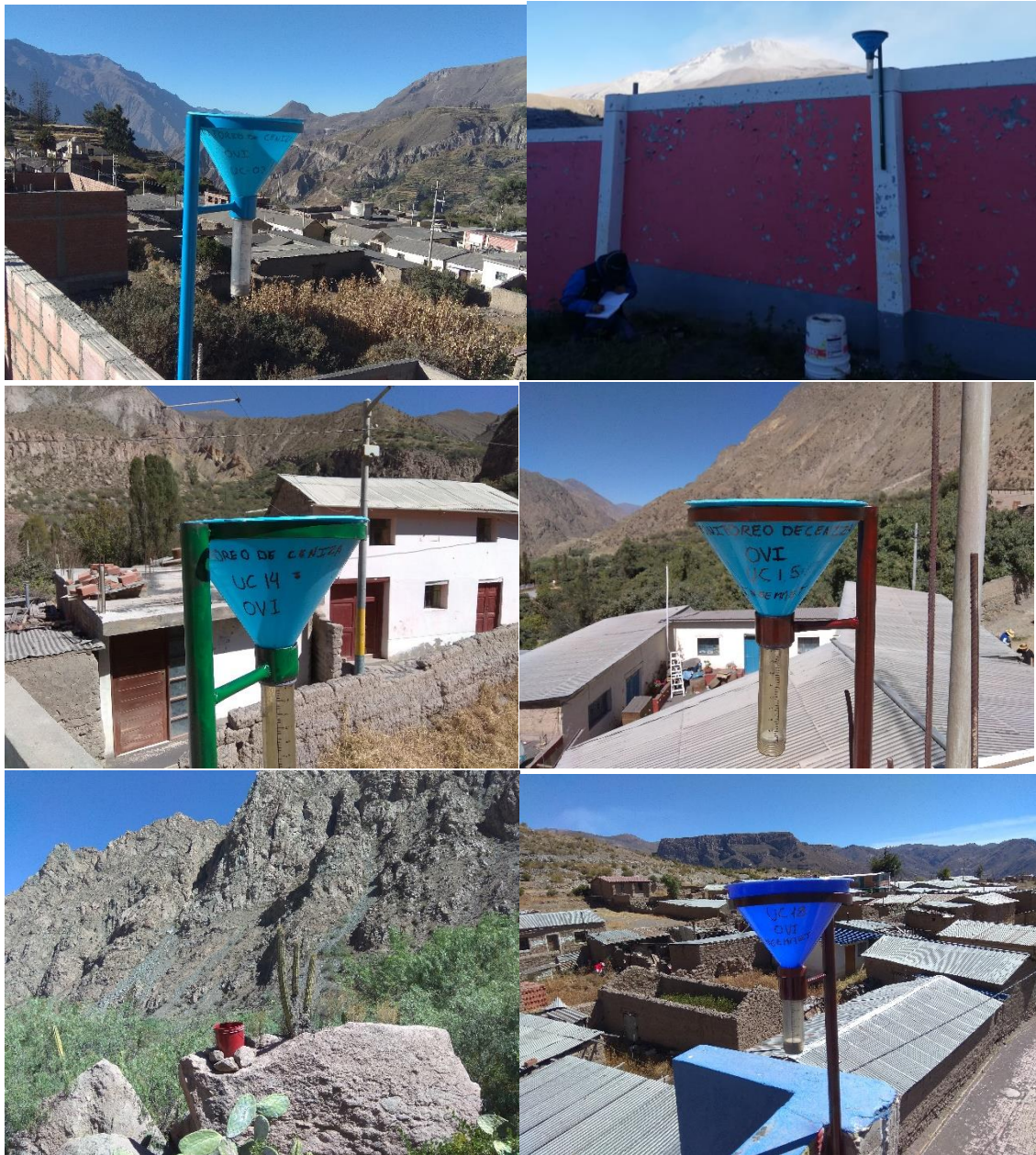
Figura 5: Instalación de cenizómetros en : a) UC-04 poblado de ubinas; b) UC-13 poblado de Escacha; c) UC-14 poblado de Huatagua; d) UC-15 poblado de Matalaque; e) UC-16 poblado de Huarina; UC-18 poblado de Chojata
