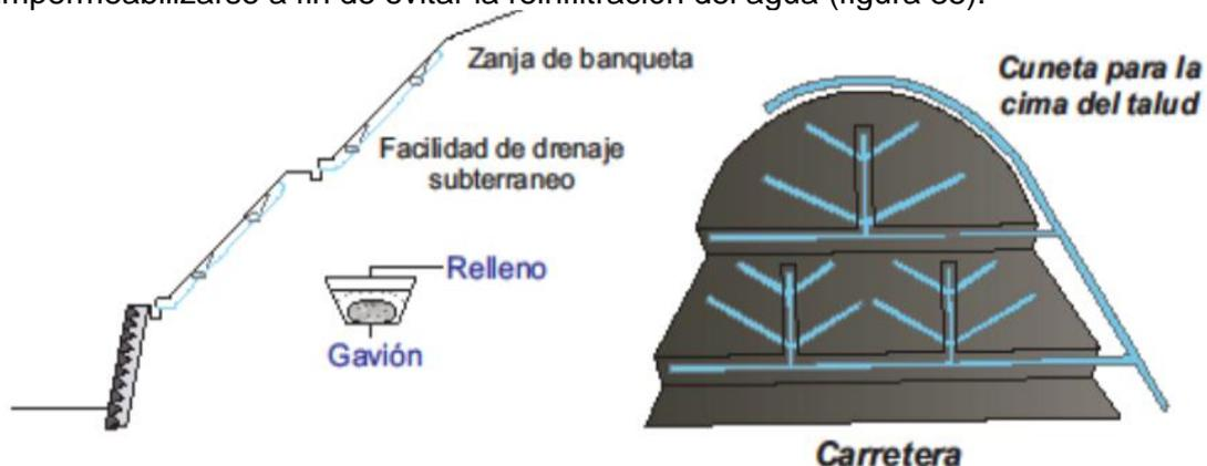
Figura 35. Esquema de drenaje dendrítico.
