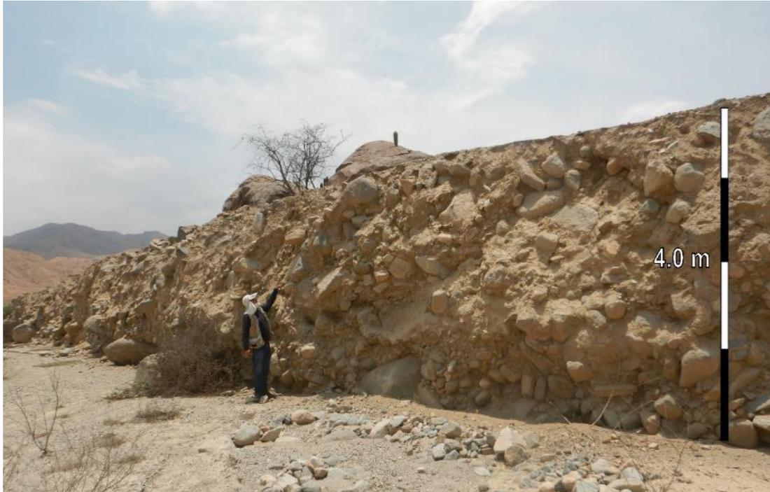
**Figura 5.** Material de depósito proluvial de hasta 4 m de altura compuesto por fragmentos de roca subangulosos a subredondeados, de tamaños variables, envueltos en una matriz de arenas gruesas a finas y limos medianamente consolidados.
