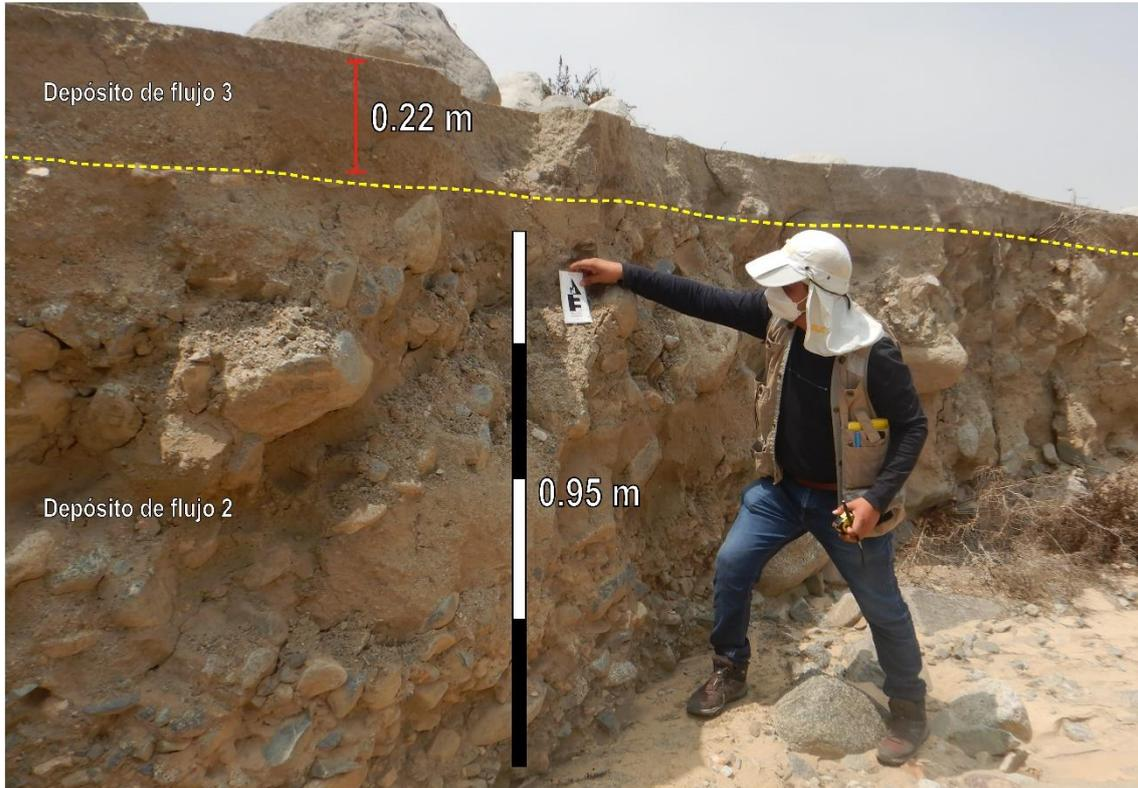
**Figura 16.** Evidencias de flujos 2 y 3. El depósito de flujo 2 presenta bloques angulosos a subangulosos con diámetros entre 0.18 m y 0.03 m envueltos en abundante matriz de arenas, limos y sobre el cual se deposita el depósito del flujo 3 de arenas gruesas a medias.
