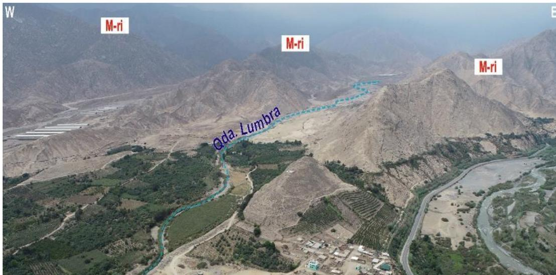
**Figura 7.** Vista de la subunidad de montañas modeladas en rocas intrusivas (M-ri), cuyas laderas presentan pendientes de fuerte a muy fuerte ( $15^\circ$ - $45^\circ$ ) y disectada por la quebrada Lumbrá.
