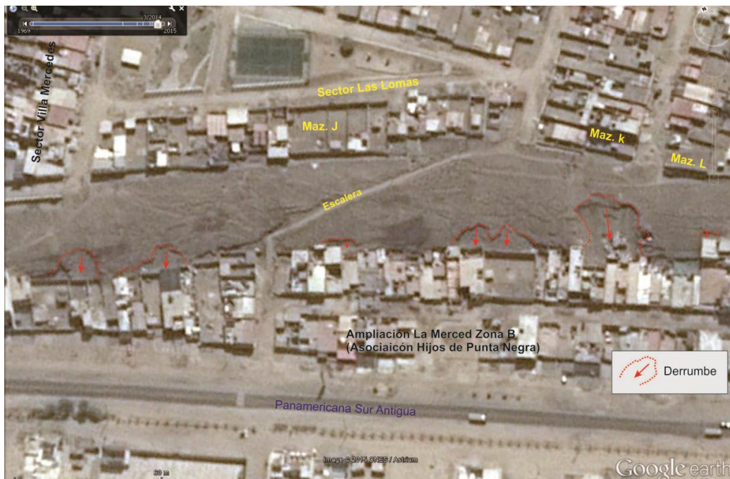
Figura 4. Se muestran los derrumbes generados por los cortes de talud (construcción de viviendas).
