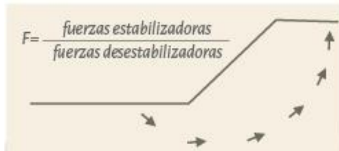
Figura 32: Esquema de estabilidad de talud.
