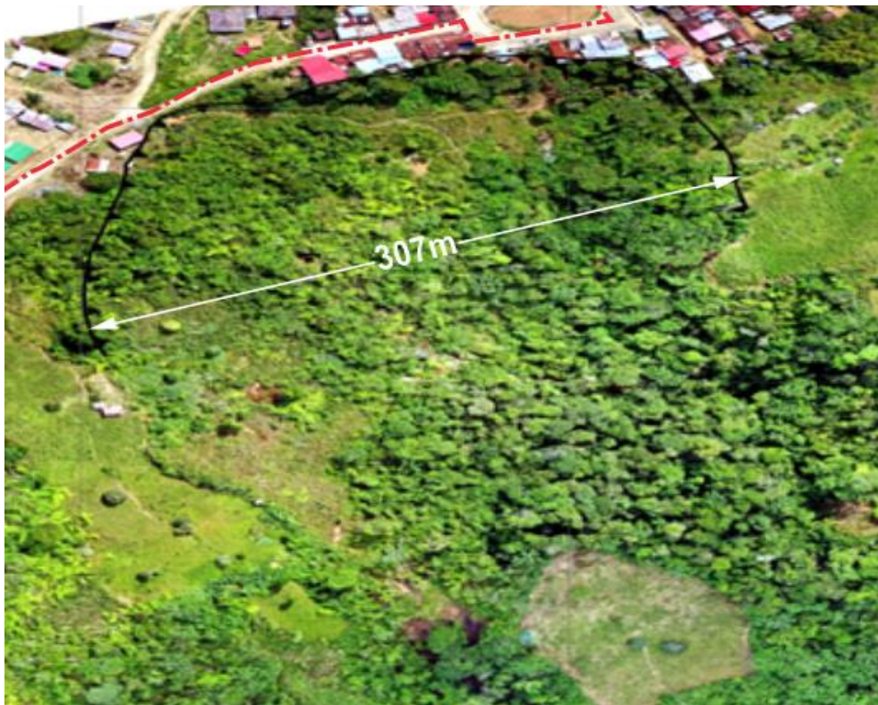
Figura 14. Vista de escarpa semicircular con longitud de escarpa de 307 m, se delimito la escarpa de línea de color negro, evento generado el 13 de setiembre del 2019.
