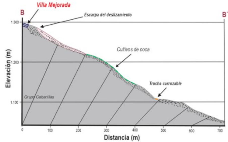
Figura 15. Perfiles longitudinales A-A' y B-B' donde se hace una comparación de los deslizamientos ocurridos al noreste y noroeste del centro poblado Villa Mejorada.
