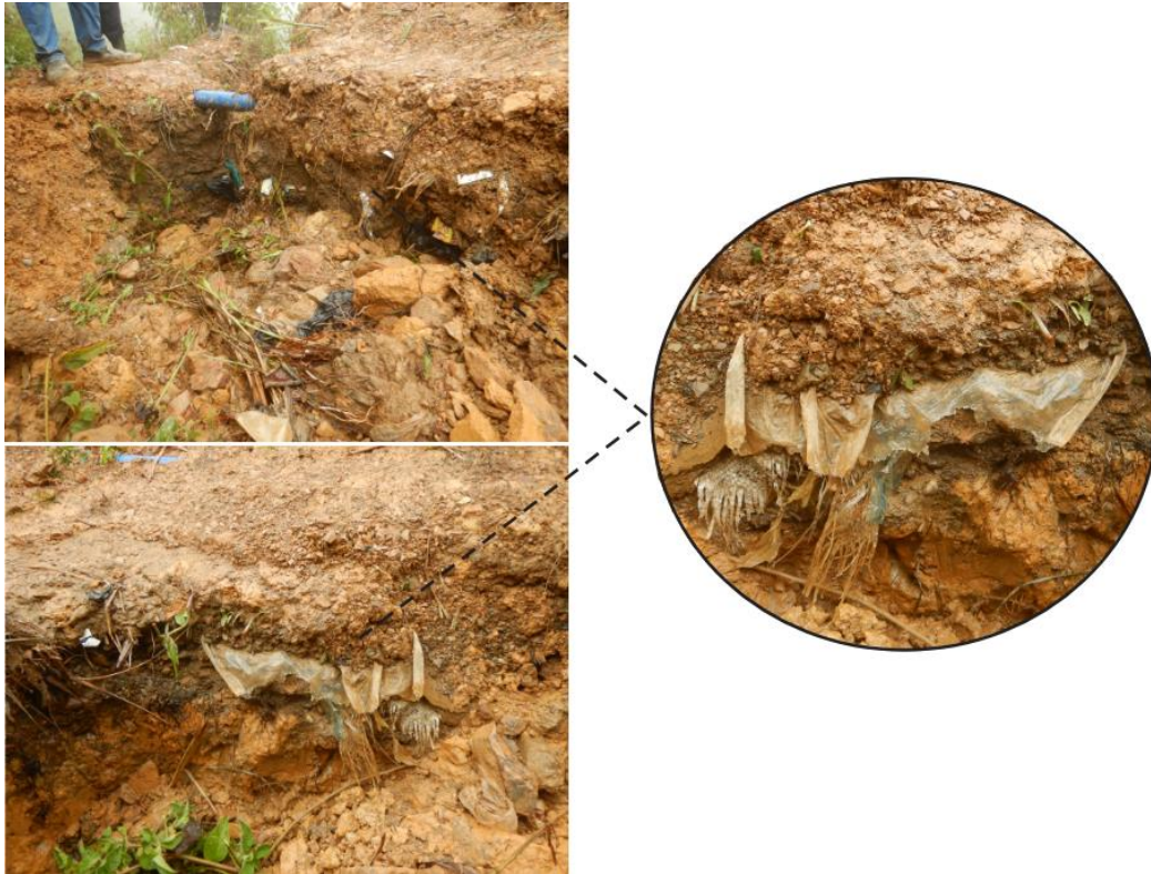
Figura 8. Vista del depósito antropógenos (Q-an), originado por la acción del hombre en el relleno de suelo.
