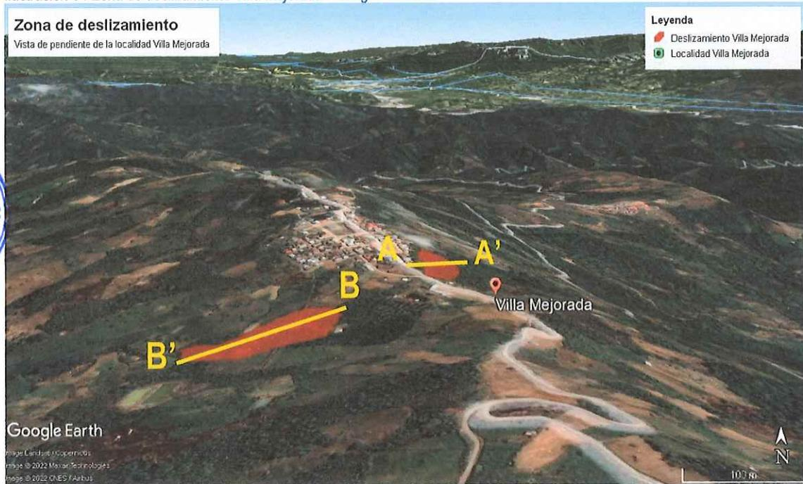
En el perfil longitudinal de la zona de deslizamiento, se observa que los deslizamientos en la localidad de Villa Mejorada afectan a las viviendas que se encuentran cercanas a las zonas de cambio de pendiente empinada y moderadamente inclinada, el perfil longitudinal va de punto A al punto A' en el sentido de oeste a este y el segundo perfil longitudinal va del punto B al punto B' en el sentido de este a oeste.
