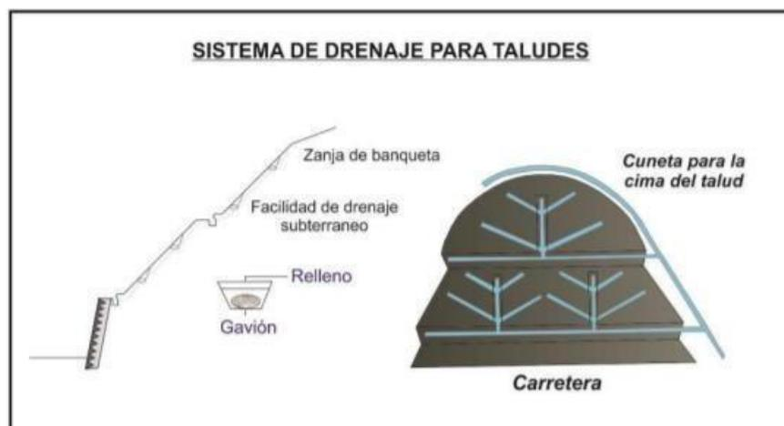
**Figura 33:** Sistema de drenaje tipo espina de pez. Fuente: Gómez, (2017) – Informe técnico N° A6753, "Peligro por deslizamiento en el sector Lluscapampa".
