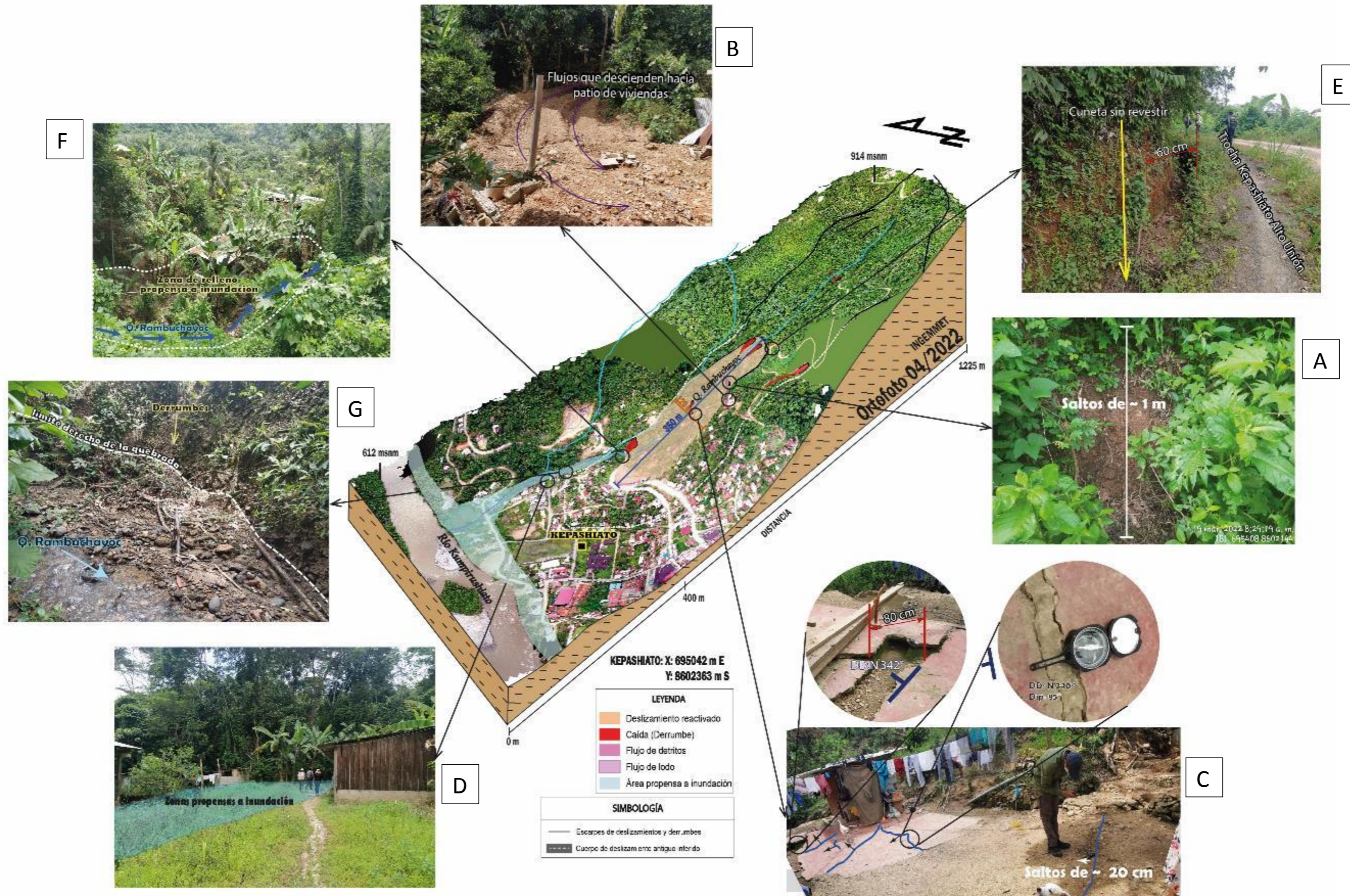
Figura 4. Vista 3D del área de estudio. Cartografiado de peligros geológicos por movimientos en masa en sector de Kepashiato. A: Saltos de 1 m en la parte media de la quebrada Rambuchayoc. B: Acumulación de materiales detríticos producto de flujos de lodo. C: Agrietamientos, aperturas y saltos aun visibles en el patio de concreto de la vivienda ubicada a <de 4 m del flanco izquierdo de la quebrada Rambuchayoc. D: zonas de inundación en la parte baja de la quebrada. E: cuneta sin revestimiento en la cabecera del deslizamiento activo. F: zona de relleno en el cauce de la quebrada Rambuchayoc. G: derrumbes y erosión en el cauce de la quebrada Rambuchayoc.
