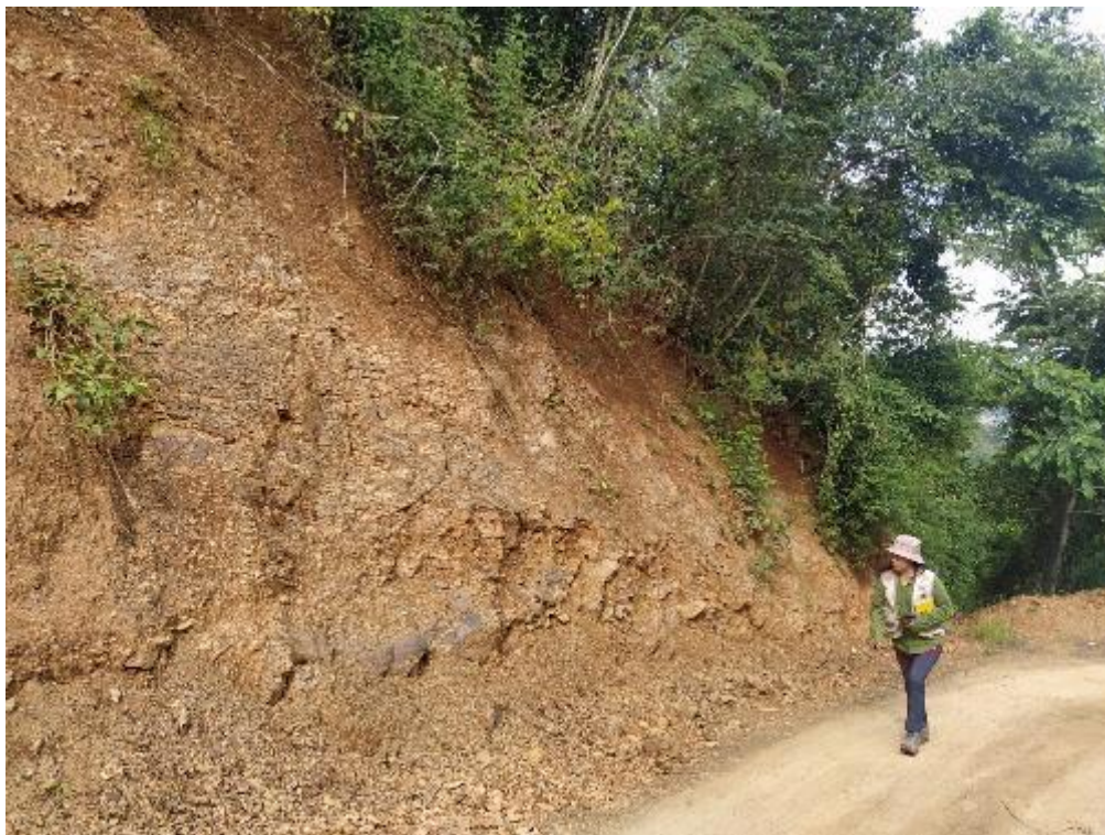
Fotografía 2. Lutitas altamente meteorizadas, donde más del 50% está descompuesta y desintegrada, se encuentran expuesta en el camino de trocha Kepashiato – Alto Unión.
