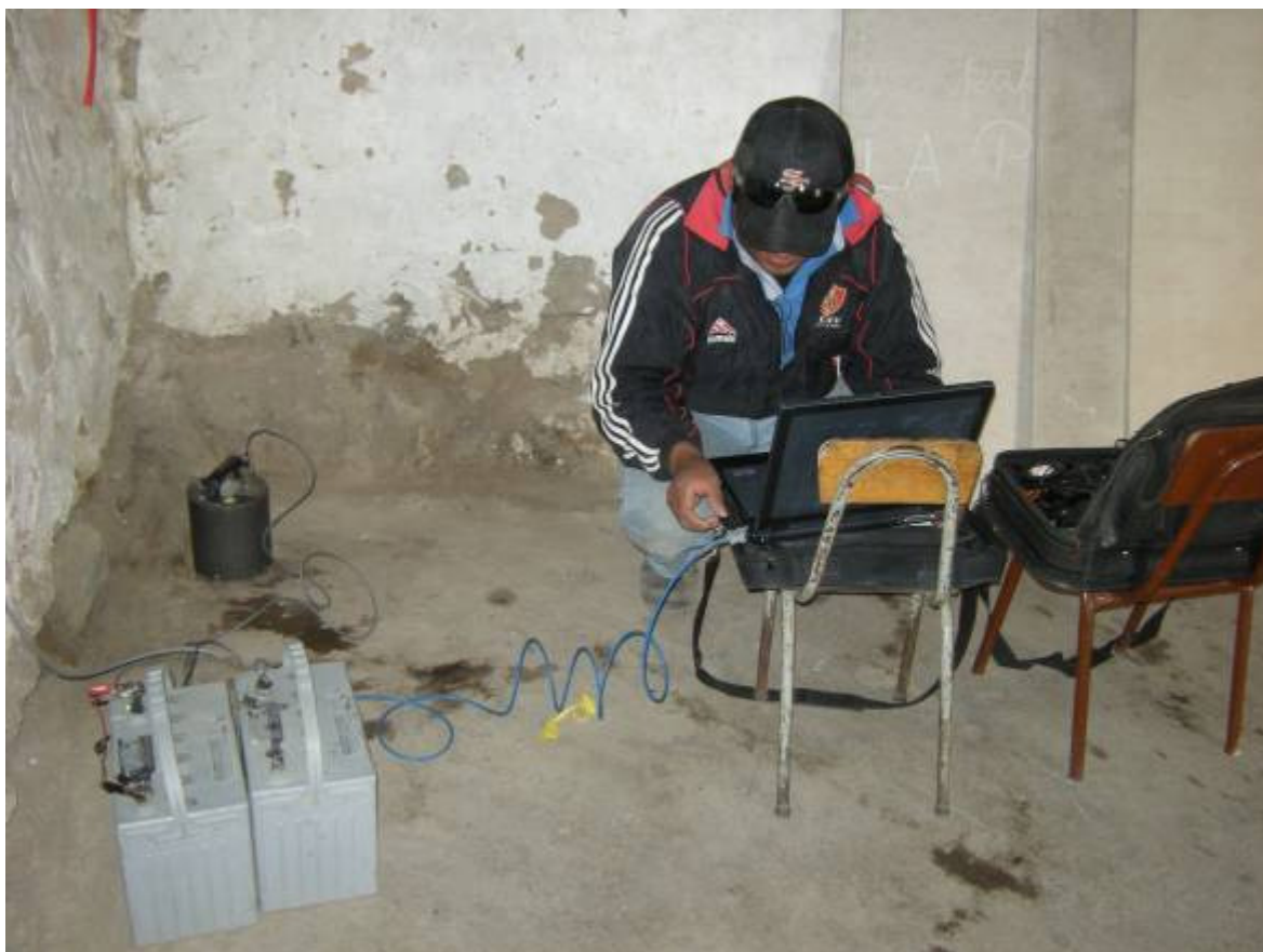
Foto N° 2.- Instalación de la estación sísmica GURALP en el pueblo de Maucallacta. Código COR1.
