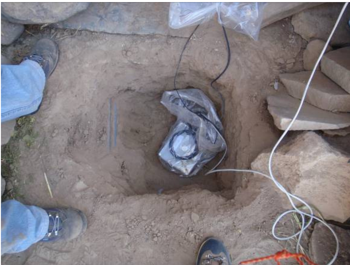
Foto N° 5.- Instalación de la estación sísmica tipo SARA en el Distrito de Viraco. Código COR3.
