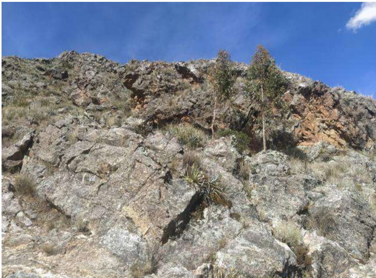
Fotografía 1. Areniscas cuarzosas de la Formación Farrat, se observan muy fracturadas, y con niveles ligeros de meteorización.
