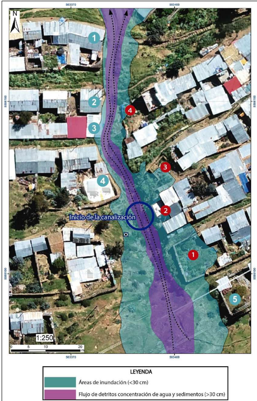
Figura 20. Representación del flujo de detritos y zonas de inundación. Las viviendas afectadas por el contacto del flujo (parte líquida) se representan en números de coloración celeste. Mientras que las viviendas afectas por el contacto directo del flujo (mezcla de sólido y líquido) e inundaciones considerables en el patio de las viviendas y alrededores se representan en color rojo.
