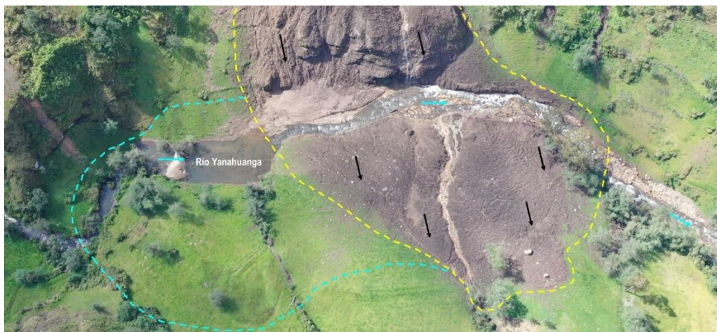
Figura 46. Vista detallada de la parte baja del flujo, donde se aprecia el avance del material hacia la colina opuesta y la zona de embalse. La ubicación de esta fotografía se presenta en la Figura 43 (3).
