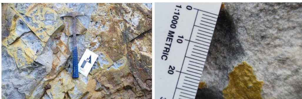
Figura 17. Vista de un macizo rocoso alterado hidrotermalmente (sílice masiva) en el cerro Chicche (izquierda) y detalle a la matriz original totalmente borrada por dicha alteración (derecha).
