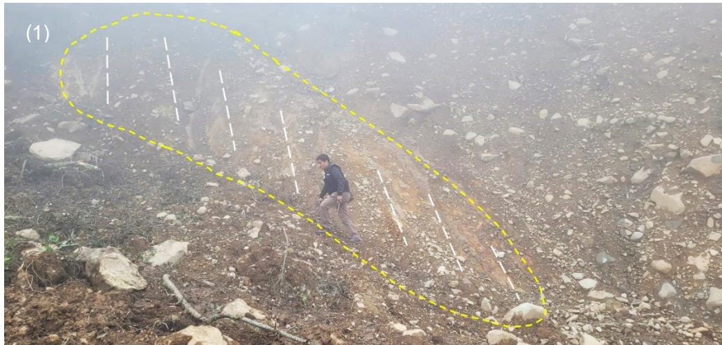
Figura 44. Detalle de la zona de movimiento donde se aprecia la superficie de deslizamiento, conformado por las andesitas alteradas hidrotermalmente. La ubicación de esta fotografía se la Figura 43 (1).
