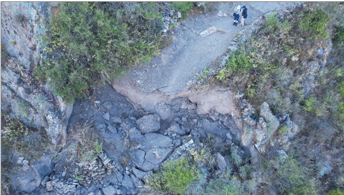
Fotografía 6. Vista del desplazamiento de hasta 2.6 m, en depósitos de deslizamientos antiguos. Fotografía tomada por Antamina.
