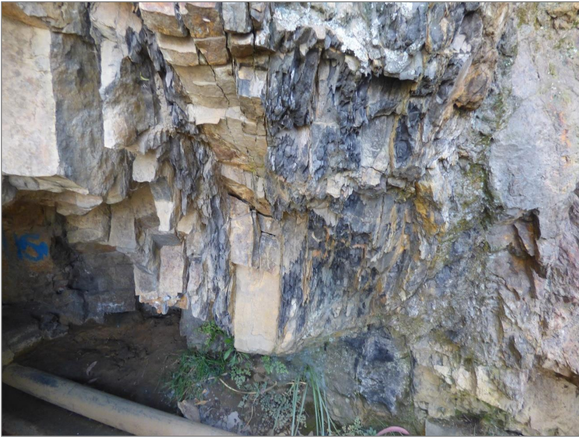
Fotografía 2. Vista de afloramiento rocoso de areniscas, intercaladas con lutitas negras, se presentan de mediana a muy fracturadas.
