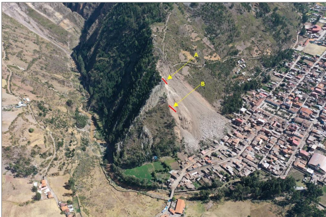
Figura 6. La pendiente escarpada de la ladera noreste del cerro Cruz de Shallapa, favoreció la ocurrencia del derrumbe (Fotografía: Antamina). A) 55° B) 75°
