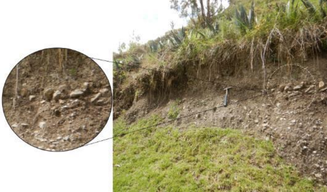
Figura 7. Depósitos coluviales provenientes de movimientos de masa antiguas, ubicadas al costado de la carretera Cashaucro a la mina Raura.
