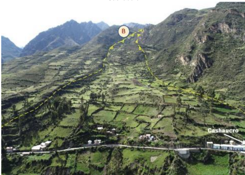
Figura 17. Se observa la escarpa principal del deslizamiento A, en la parte superior de sector Cashaucro.
