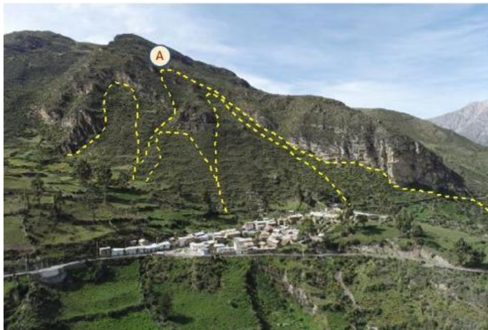
Figura 17. Se observa la escarpa principal del deslizamiento A, en la parte superior de sector Cashaucro.
