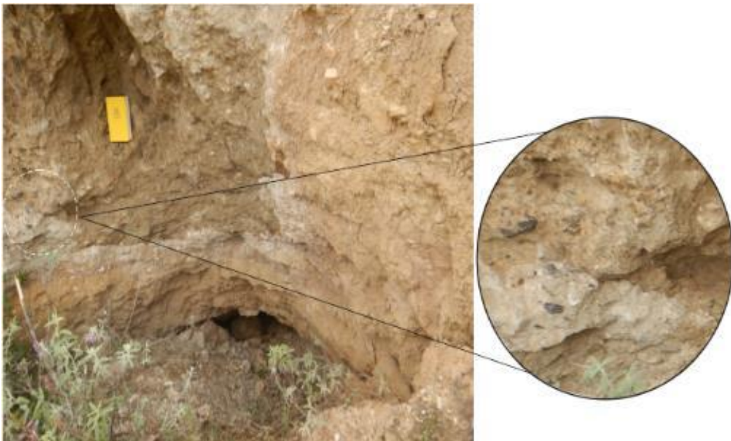
Figura 6. Material del depósito coluvio-deluvial compuesto por fragmentos de roca anguloso a subangulosos de tamaños variables, envueltos en una matriz limo-arcilloso.
