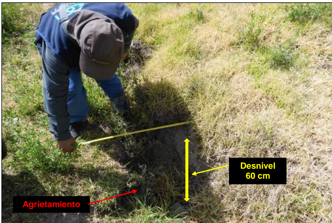
Figura 9. Deslizamiento en el sector de Yarapampa (RCT1), agrietamientos de hasta 60cm de desnivel (coordenadas UTM E: 300499, N: 8185236)
