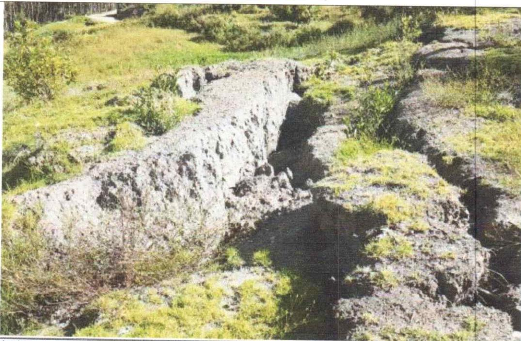
Agrietamientos severos que dañan terrenos agrícolas, muros y plantaciones de eucalipto que han sido afectados directamente.
