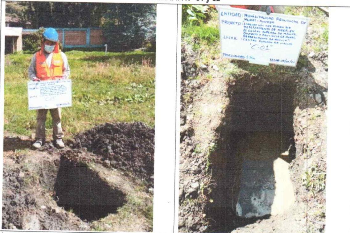
La calicata C-01, de 1.50 m de profundidad, se ejecutó dentro del Centro de Salud del Centro Poblado de Mallas, con coordenadas 258956.63 m E y 8959973.52 m S.
