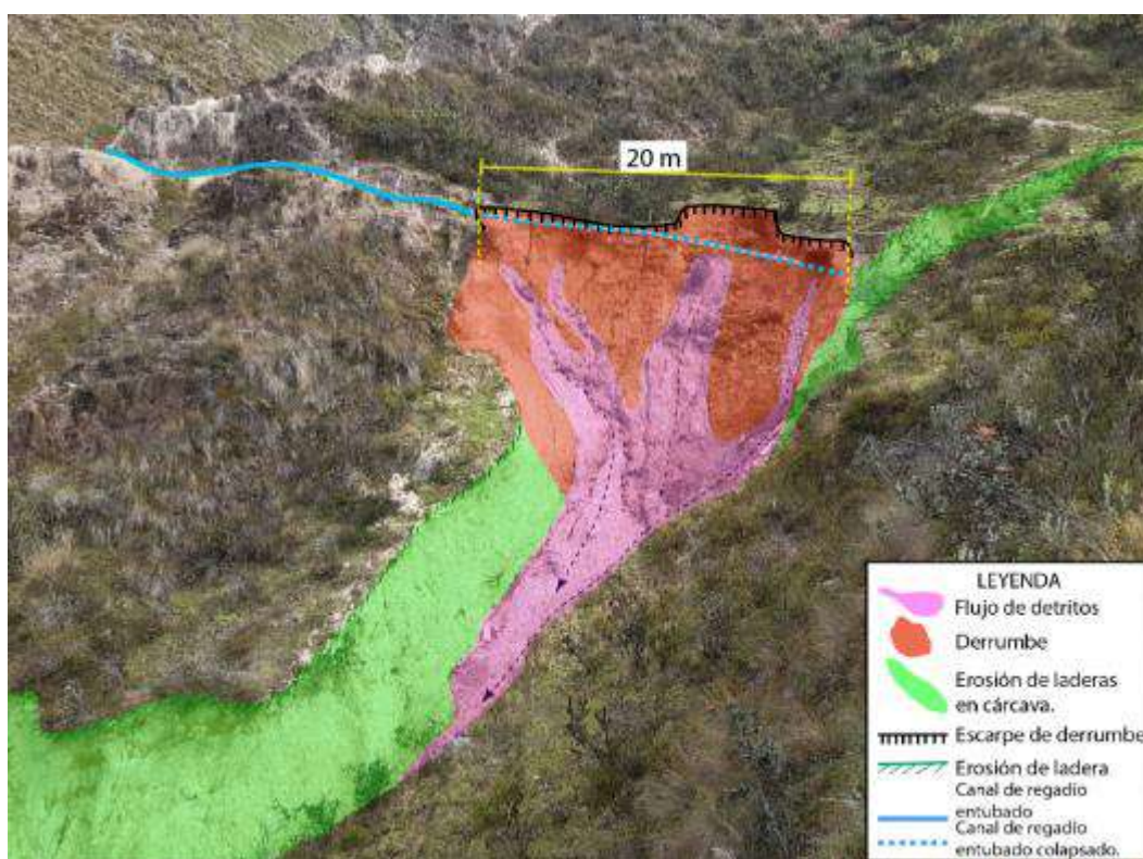
Figura 19. Cartografiado del peligro geológico por movimientos en masa de tipo derrumbe seguido por un flujo de detritos, el cual se encausa por la cárcava.
