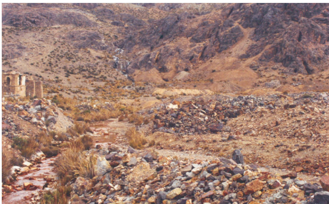
Foto N° 121 Pasivo ambiental dejado por la mina Suyckutambo (Cusco), donde se encuentran 2 a 3 niveles de material que ocupa una área de 120 m de largo x 60 m de ancho (vista superior). En la parte alta cerca de las bocaminas y socavones abandonados, después de pasar por los botaderos, se observa la presencia de aguas ácidas de bajo caudal (vista inferior)
