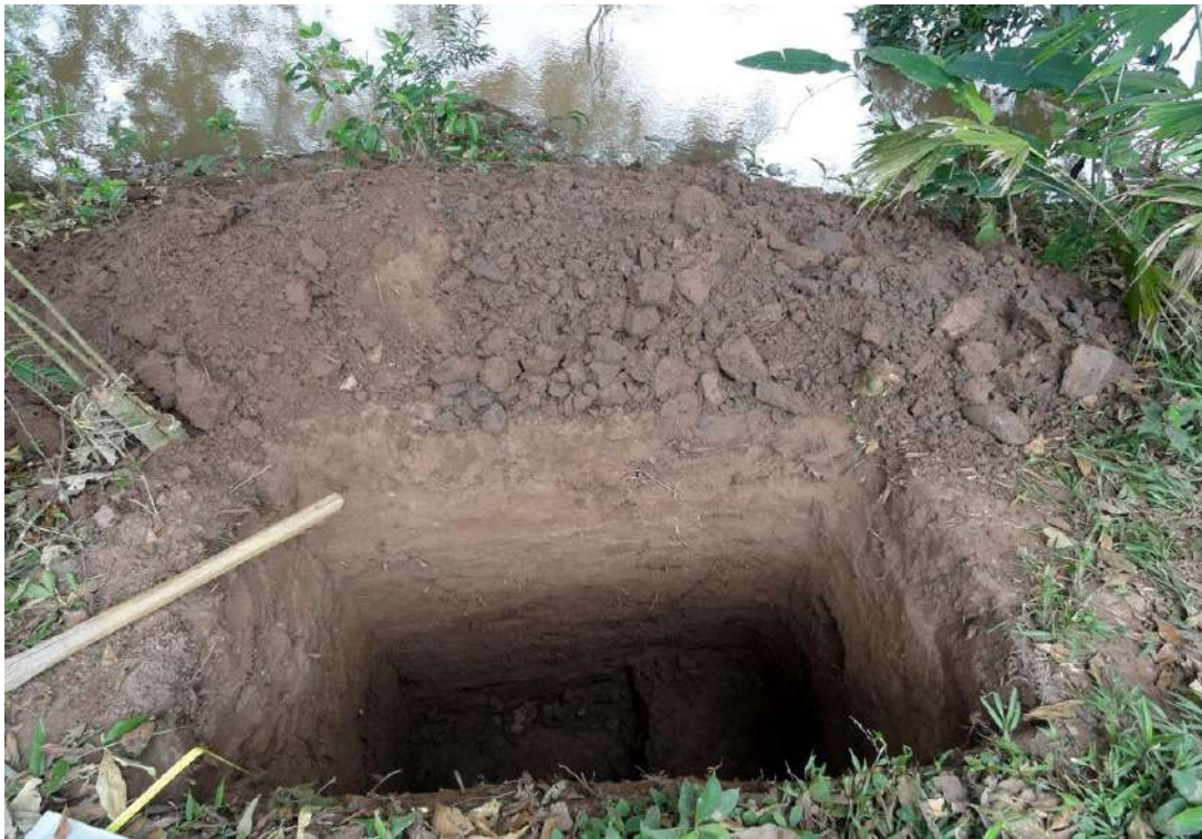
Figura 26.- Calicata N° 2. Depósito Arcillo limo arenoso. Margen Izquierda terraza baja frente a la localidad de San Regis.
