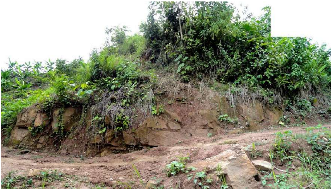
Figura 12.- Vista del afloramiento rocoso de la formación Ipururo, que está compuesto la colina estructural de la margen derecha del río Saposoa en la localidad de Pasarraya, es una arenisca bastante fracturada y de moderada resistencia de color gris parduzco matiz amarillenta.
