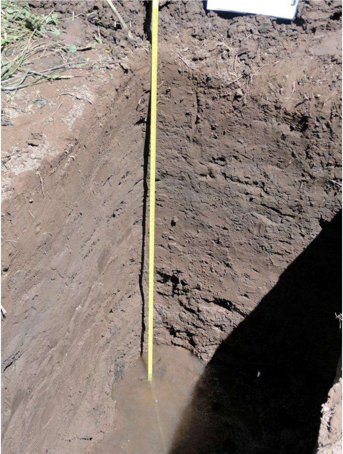
Figura 27.- Calicata 3. Depósito Arcillo limo arenoso. Margen derecha de la terraza baja al Oeste del distrito de Saposoa.
