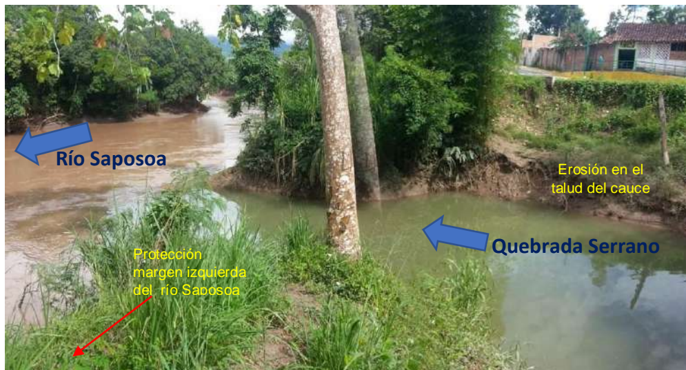
Figura 34. Riesgo por inundación y por erosión durante época de máximas venidas, sector desembocadura del río Serrano.
