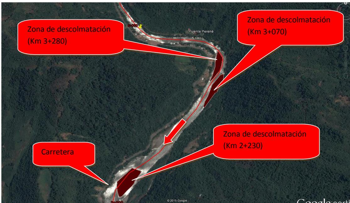
Figura N° 38 Se aprecia el peligro en la carretera y la propuesta de descolmatación
