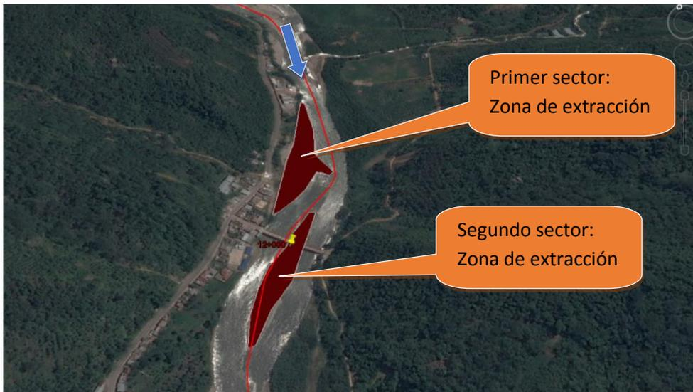
Imagen Satelital 01. Zona de extracción de material de acarreo Km 12+225 y Km 11+800.
