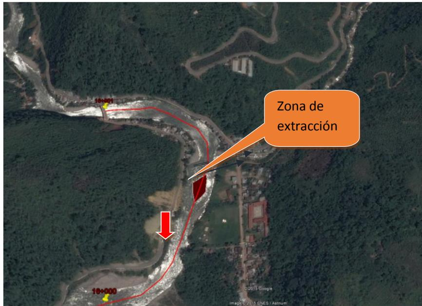
Imagen Satelital 01. Zona de extracción de material de acarreo Km 16+410.
