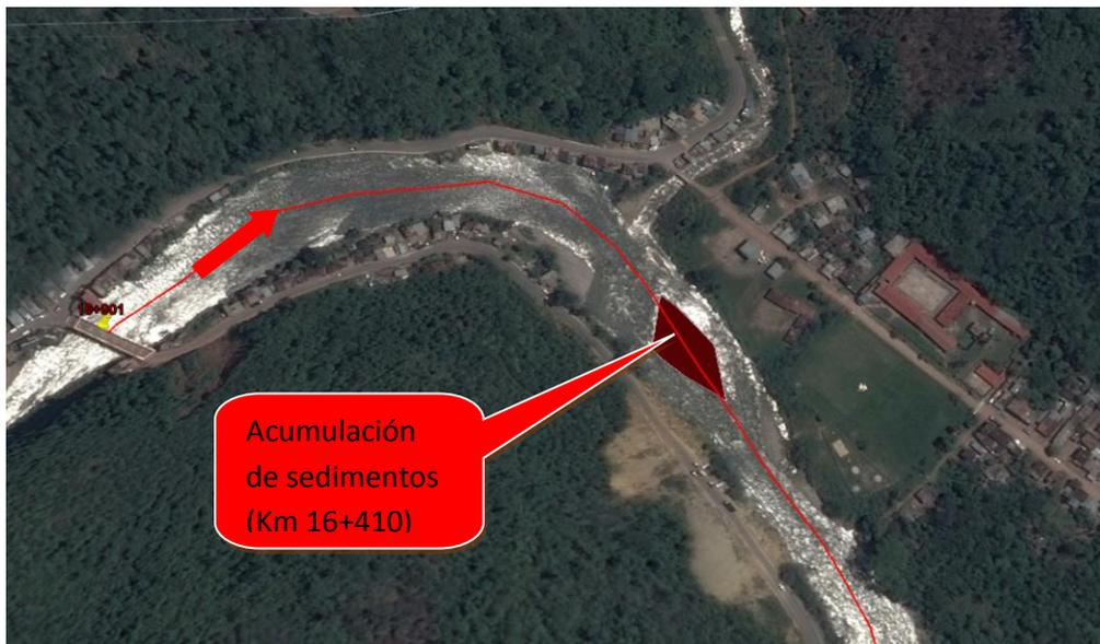
Figura N° 34 Se aprecia el desarrollo del río y la zona colmatada.
