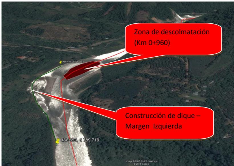
Figura 37 Se aprecia el cambio del flujo del río y la propuesta de dique y la descolmatación del cauce
