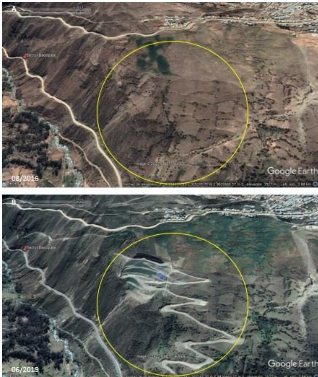
Figura 23. Vista de imágenes multitemporales tomadas de Google Earth, en círculo amarillo en imagen (A) aún sin trazo de carretera (2016) y B (2019) vía construida sobre carretera Viroc-Raura, se observa también nuevos caminos de herradura en el área, los que aceleran los movimientos en masa en el sector de estudio.
