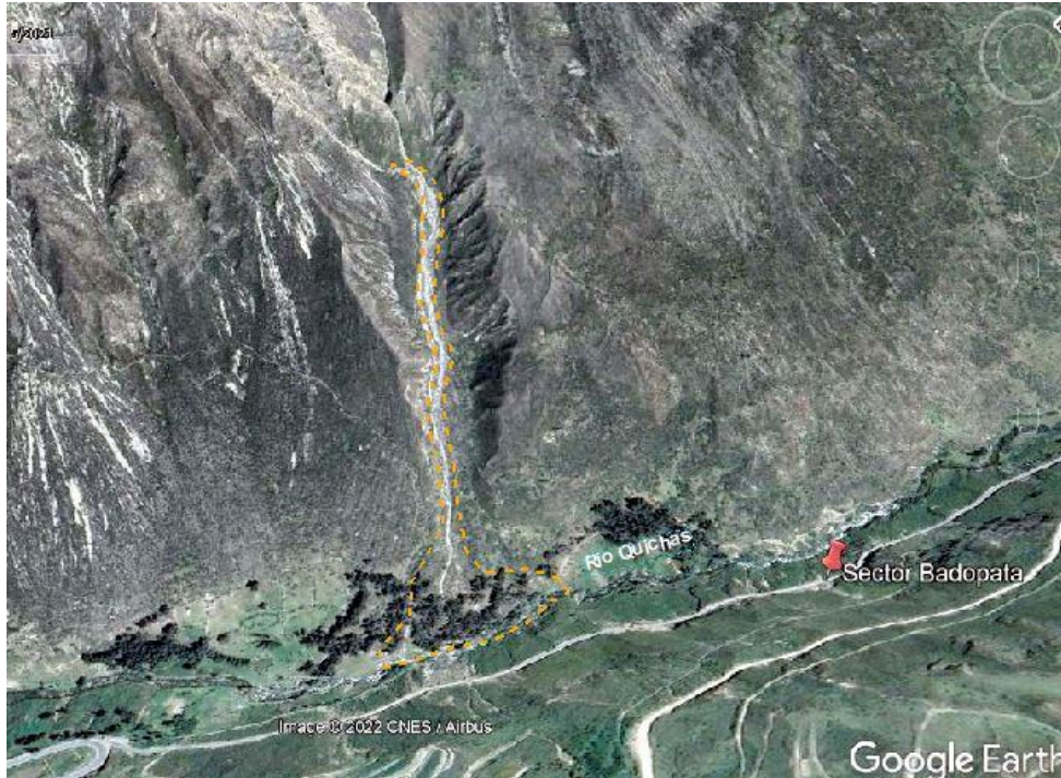
Figura 10. Vista de imagen Google Earth, Material del depósito proluvial compuesto por fragmentos de tamaños variables, subanguloso a subredondeado en un matriz fina, el flujo se desplaza hacia el río Quichas.
