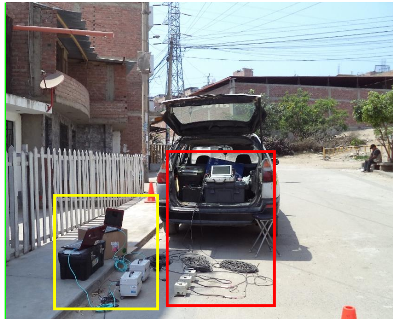
Figura 7.4. Equipos e instrumentos utilizados durante la medición puntual de microtremores. Izquierda: sensor Tokyo Sokushin modelo CV-374 AV2. Derecha: Sensor y sistema de adquisición GEODAS-ANET
