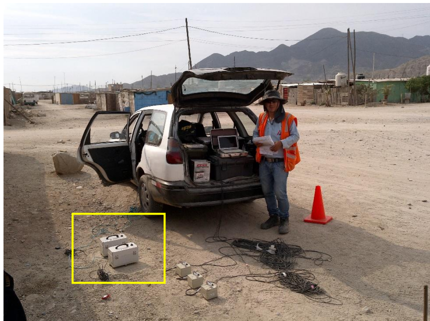
Figura 7.6. Ejecución del ensayo de medición puntual de microtemores en el distrito de Cieneguilla utilizando los sensores Tokyo Sokushin
