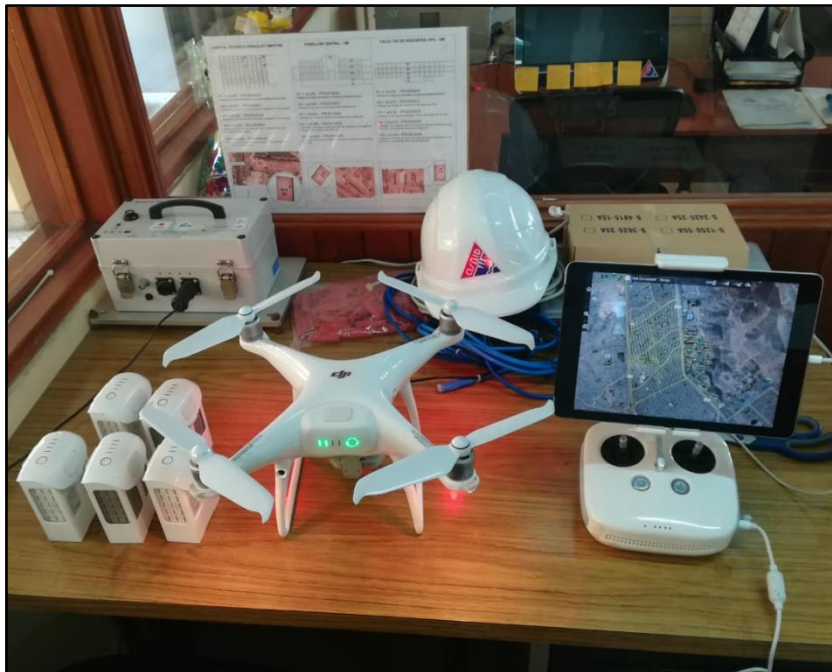
Figura 5.1.1 Equipos utilizados durante el levantamiento fotogramétrico
