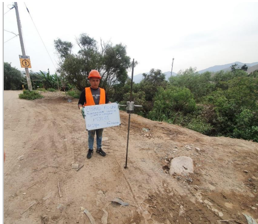
Figura 7.2. Ensayo de Penetración Ligera en el distrito de Cieneguilla
