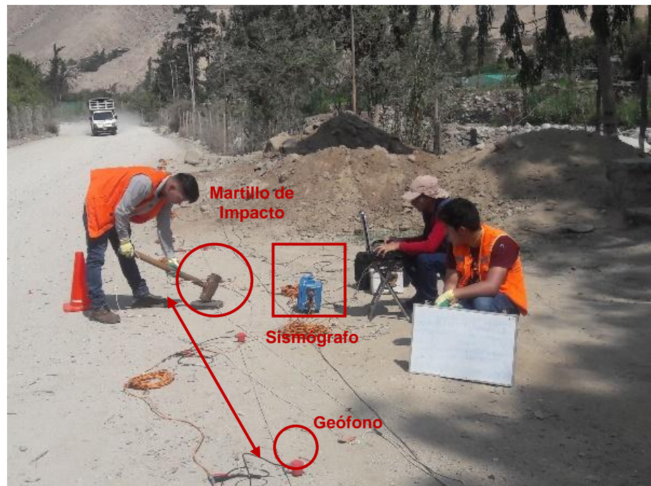
Figura 7.9. Ejecución del ensayo de refracción sísmica en el distrito de Cieneguilla
