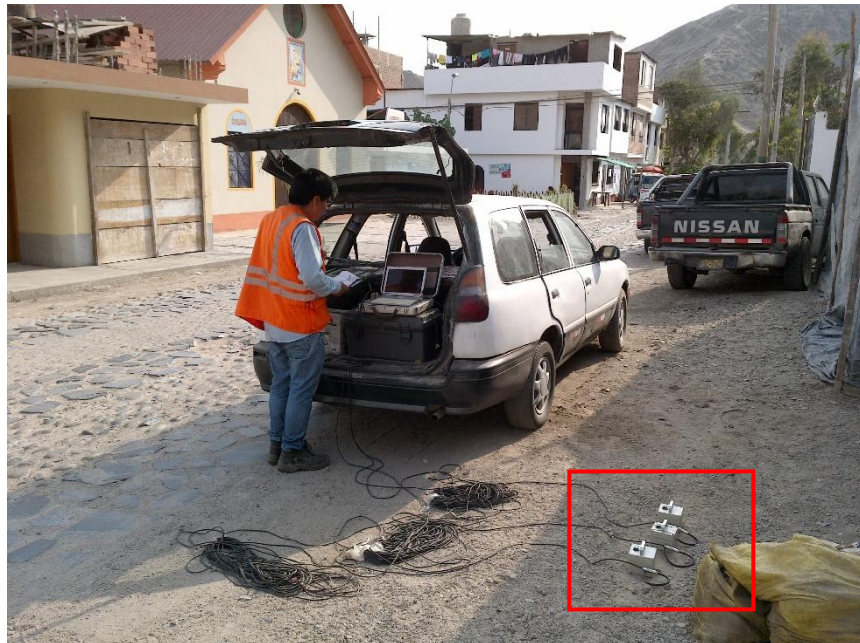
Figura 7.5. Ejecución del ensayo de medición puntual de microtemores en el distrito de Cieneguilla utilizando los sensores ANET
