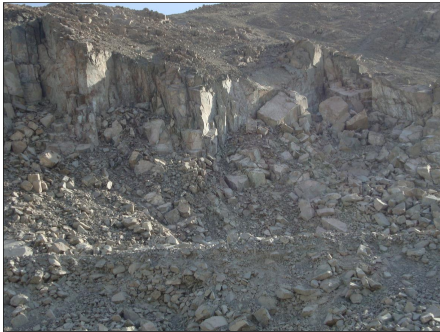
Foto N° 08: Afloramientos rocosos de naturaleza intrusiva de color gris claro y textura granular corresponden a la Cantera Santa Rosa.
