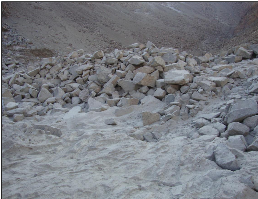
Foto N° 12: Cantera Ayanqueros, constituida por rocas tipo andesitas la potencia de explotación supera los 2 metros.
