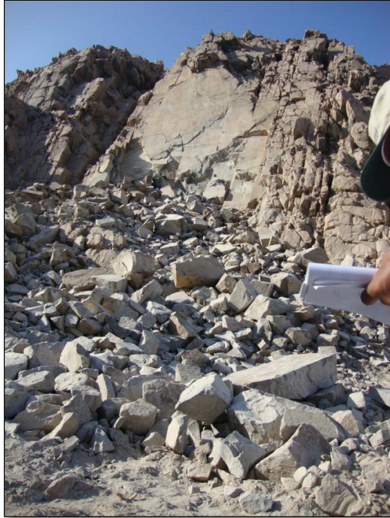
Foto N° 09: Cantera Santa María, se observan rocas tipo andesitas poco alteradas y muy fracturadas.
