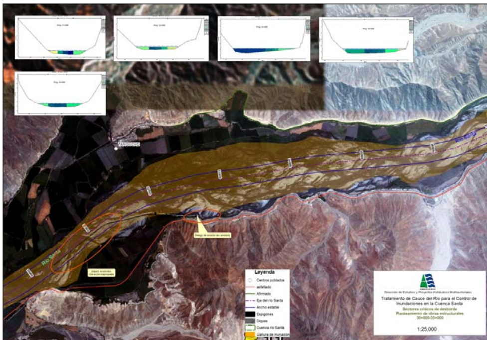
Figura 36. Ubicación de los puntos críticos y diques existentes, progresiva 30-35+000
