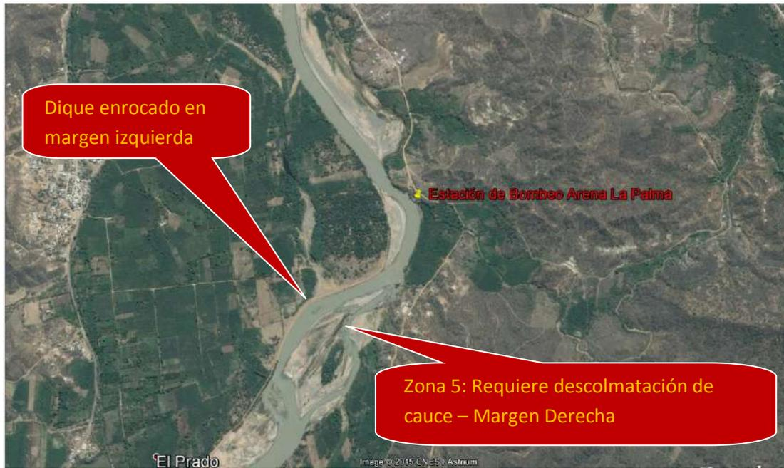
Figura 50 Se aprecia el dique enrocado y la zona 5 que requieren descolmatación
