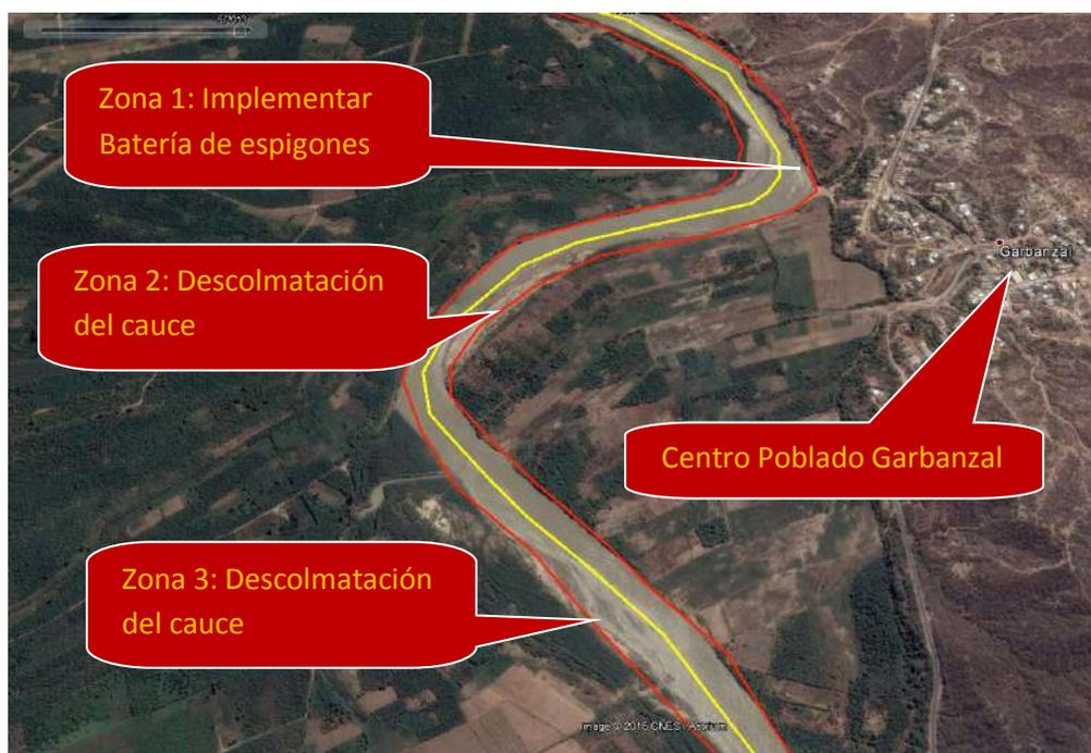
Figura 43. Se aprecia el desarrollo natural del río Tumbes y zonas que necesitan descolmatación del cauce (Zonas 2 y 3) y la implementación de batería de espigones (Zona 1)
