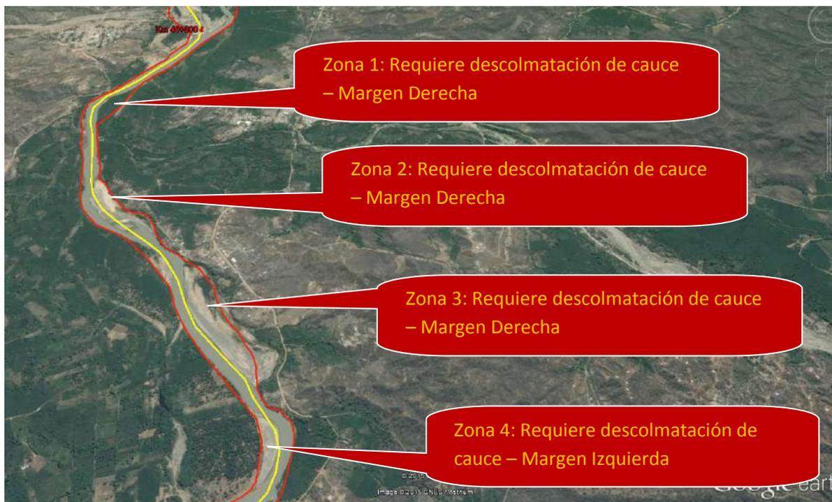
Figura 49. Se aprecia el desarrollo del río y las zonas que requieren descolmatación
