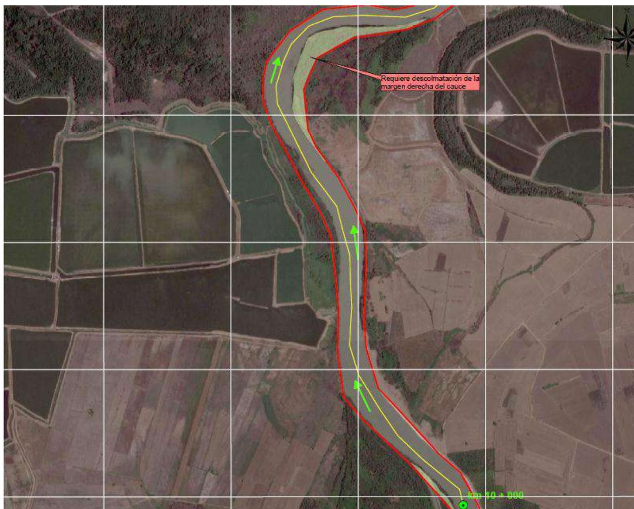
Figura 55 Se aprecia la propuesta de descolmatación del cauce en las curvas
