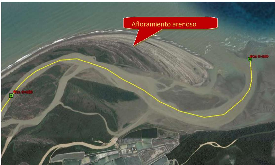
Figura 38. Se aprecia el afloramiento arenoso que impide la libre desembocadura en el mar.
