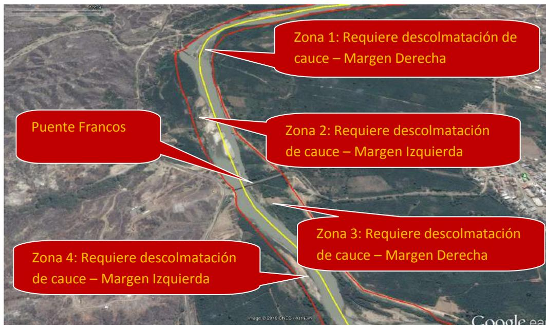
Figura 47. Se aprecia el Puente Franco y las zonas del cauce que requieren descolmatación
