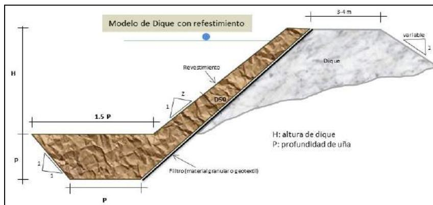
Figura 29. Modelo típico de defensa ribereño enrocado
