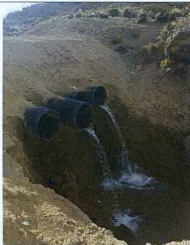
Foto 7: sección de aforo aguas abajo de la confluencia de la Quebrada Vizcachane (Km 0+155) y Quebrada Huaylillas.
