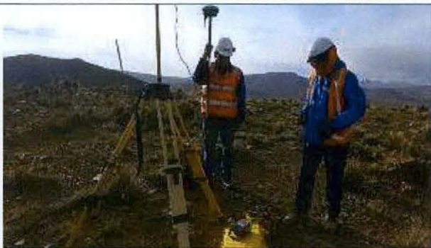
Foto 3: Instalación de equipo GPS Diferencial para prueba de confiabilidad de estación repetidora de base.
