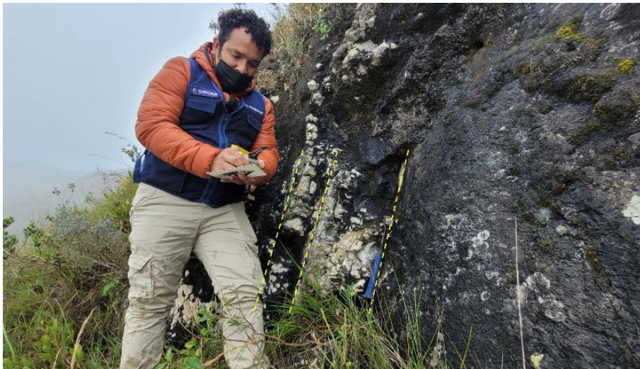
Figura 3. Formación Chúlec, estratos con Rumbo: 270° y Buzamiento: 77°. (Coordenadas UTM WS-84 -17S, Norte: 9242778 – Este: 805201).
