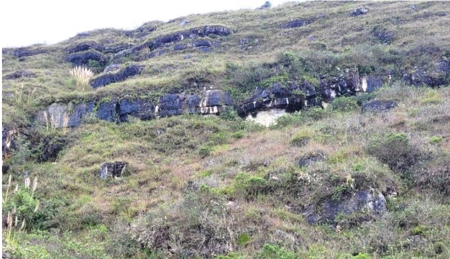
Fotografía 3. Calizas ligeramente meteorizadas, poco fracturadas. (Coordenadas UTM WS-84 -17S, Norte: 9242862 – Este: 805250).
