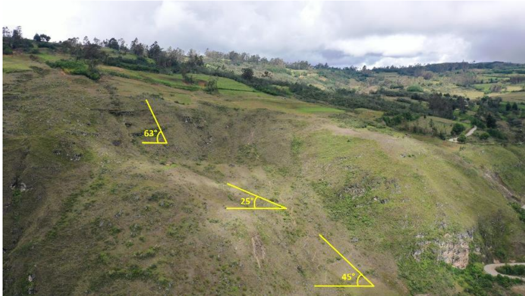
Figura 5. Variación de pendientes (fuerte – 25^\circ , muy fuerte – 45^\circ y escarpada 63^\circ ), ubicadas en la parte superior a la localidad de Huasmín (dirección oeste).
