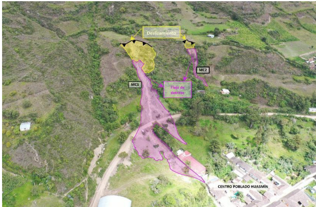
Figura 13. Movimientos complejos ubicados al este de la localidad de Huasmín, ambos movimientos se desarrollan en dirección a la zona urbana.
