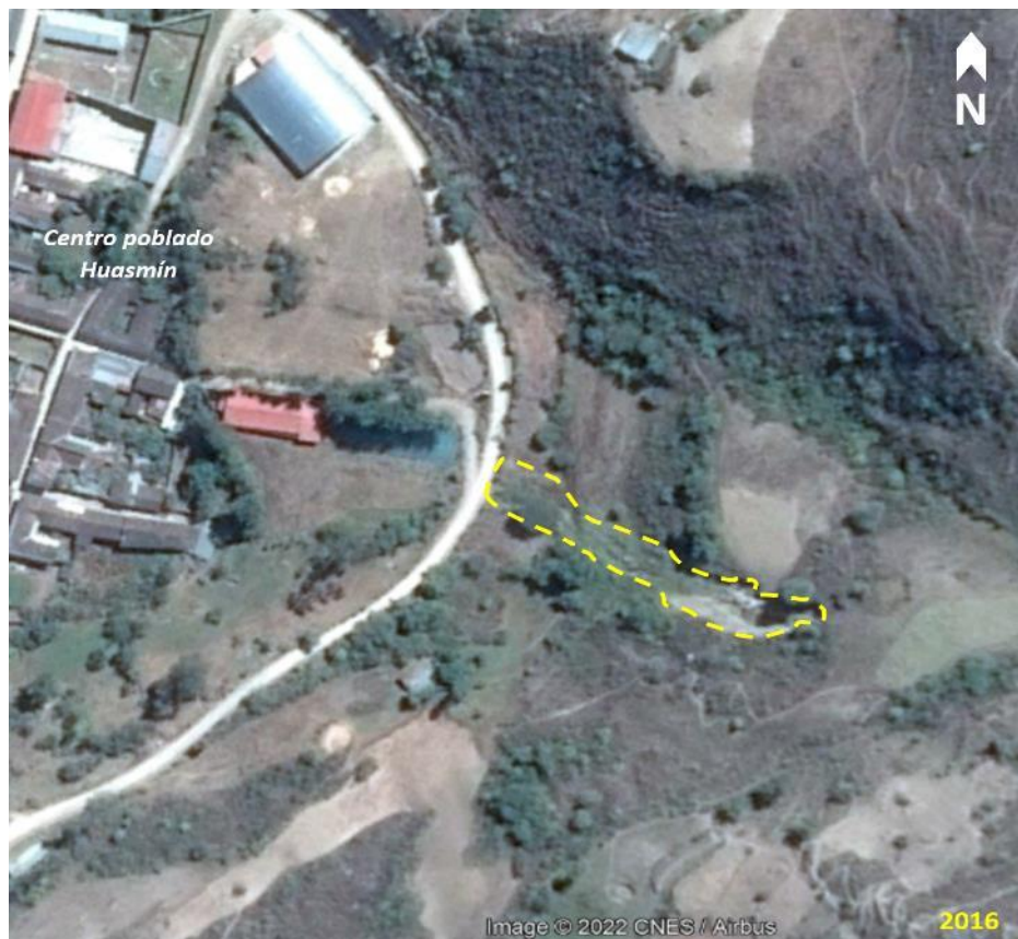
Figura 16. Se observa la activación del movimiento complejo en el año 2016. Fuente: Google Earth.
