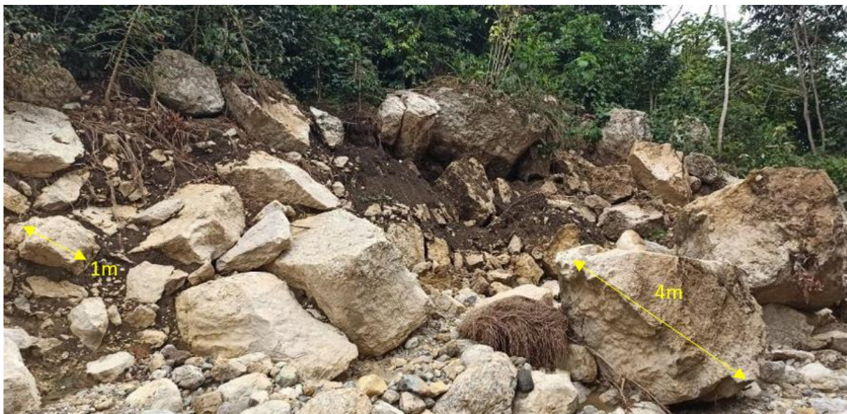
Figura 3. Material coluvio-deluvial, constituidos por bloques de caliza 1 m a 4 m sub angulosos y distribuidos de forma caótica en una matriz areno, limosa – arcillosa de compacidad baja.
