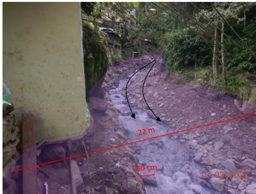
Figura 9. Parte baja de la quebrada (altura de la Avenida Wakanki), se aprecia el ancho que alcanzo el flujo en el canal de la quebrada.
