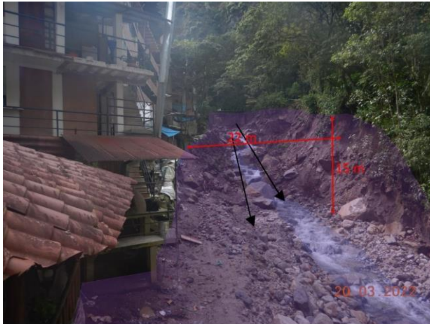
Figura 8. Parte baja de la quebrada Alcamayo, altura de la calle Qori Wakanki, se aprecia el canal por donde paso el flujo del 21 de enero y las medidas que presentó.
